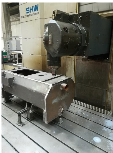
Slika 30. Mjerenje visine ticalom
