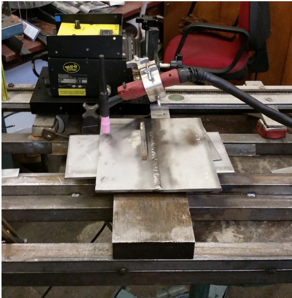
Slika 49. Prikaz pripreme radnog mjesta za navarivanje, Laboratorij za zavarivanje, FSB, Zagreb
