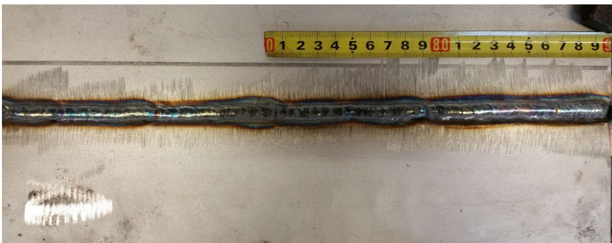
Slika 65. Prikaz drugog prolaza popune nakon zavarivanja, Laboratorij za zavarivanje, FSB, Zagreb
