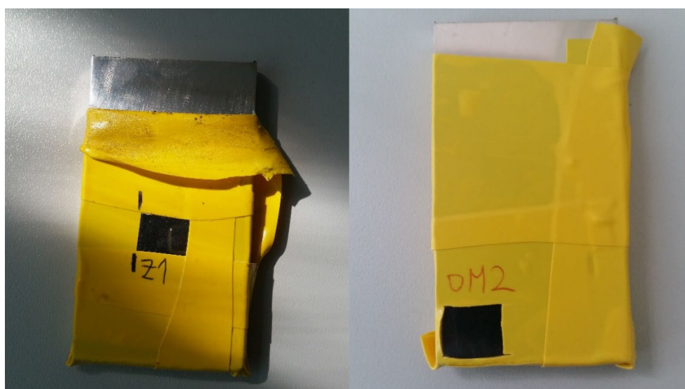
Slika 78. Prikaz ispitnog uzorka za elektrokemijska ispitivanja, Laboratorij za zaštitu materijala, FSB, Zagreb
