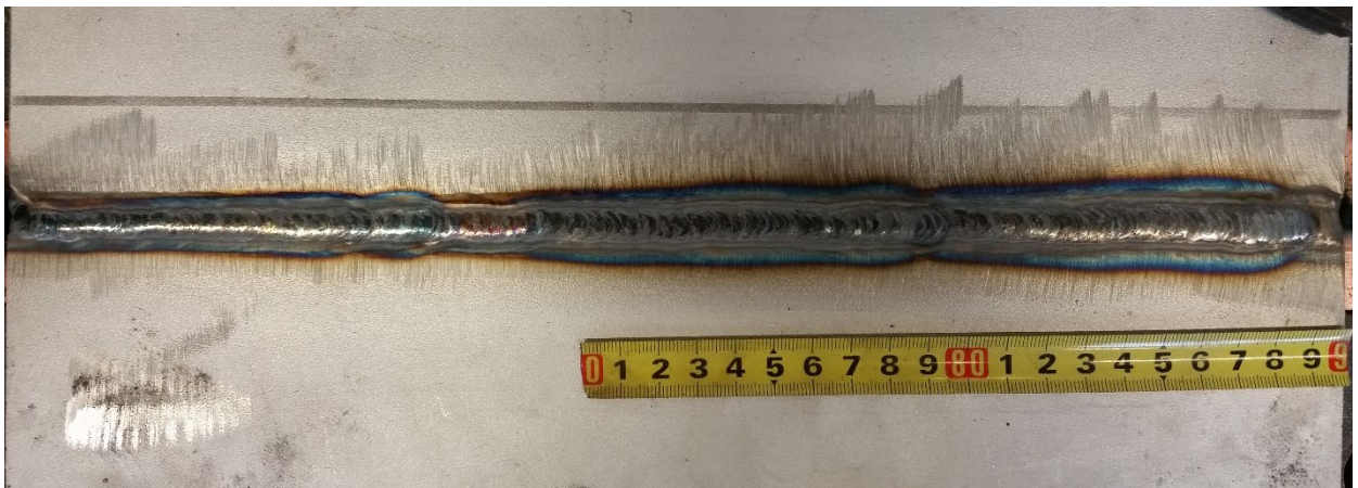
Slika 67. Prikaz trećeg prolaza popune nakon zavarivanja, Laboratorij za zavarivanje, FSB, Zagreb
