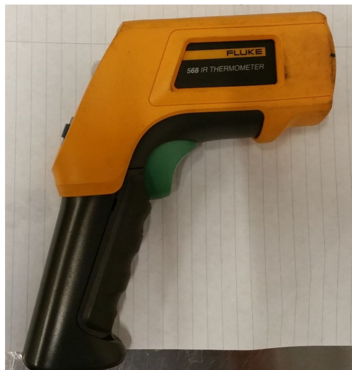
Slika 50. Prikaz postupka mjerenja temperature ispitne ploče pomoću uređaja Fluke 568, Laboratorij za zavarivanje, FSB, Zagreb
