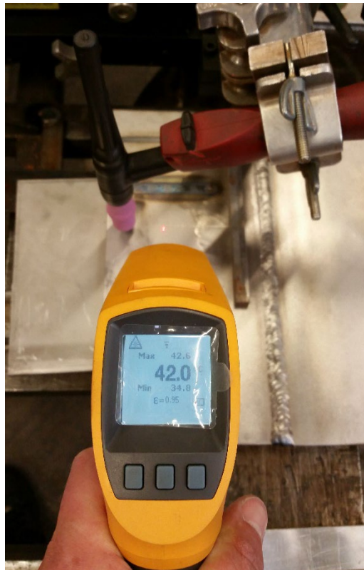
Slika 50. Prikaz postupka mjerenja temperature ispitne ploče pomoću uređaja Fluke 568, Laboratorij za zavarivanje, FSB, Zagreb
