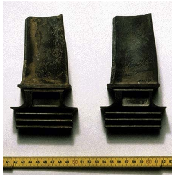
Slika 10. Prikaz sulfidizacije legure Rene 77 [19]
