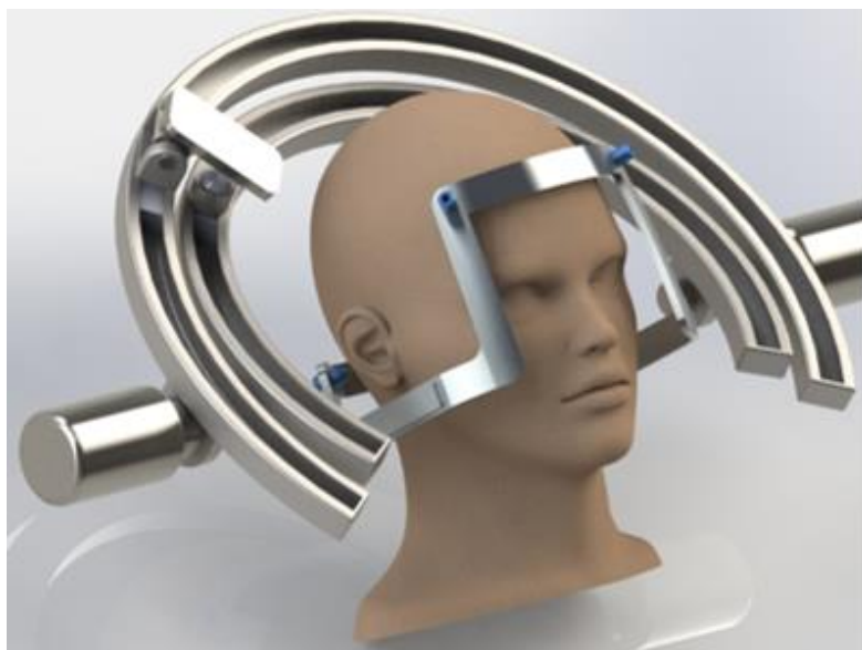
Slika 21. Idejna motorizacija Leksell-ovog okvira [17]
