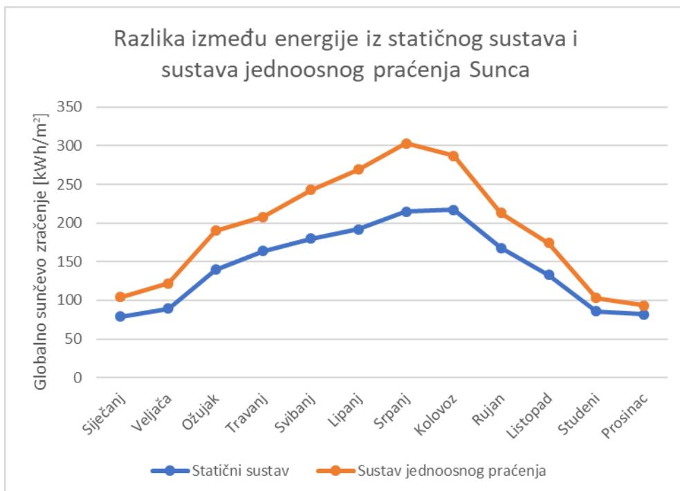
Slika 24. Razlika između energije iz statičnog sustava i sustava jednoosnog praćenja Sunca
