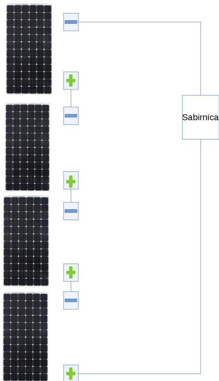
Slika 5. Serijsko spajanje fotonaponskih modula
