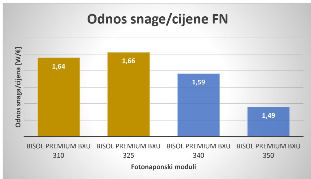
Slika 4. Odnos snage/cijene fotonaponskog modula
