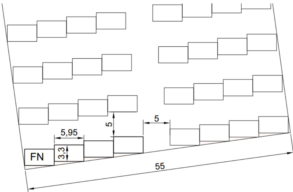
Slika 14. Raspored fotonaponskih modula
