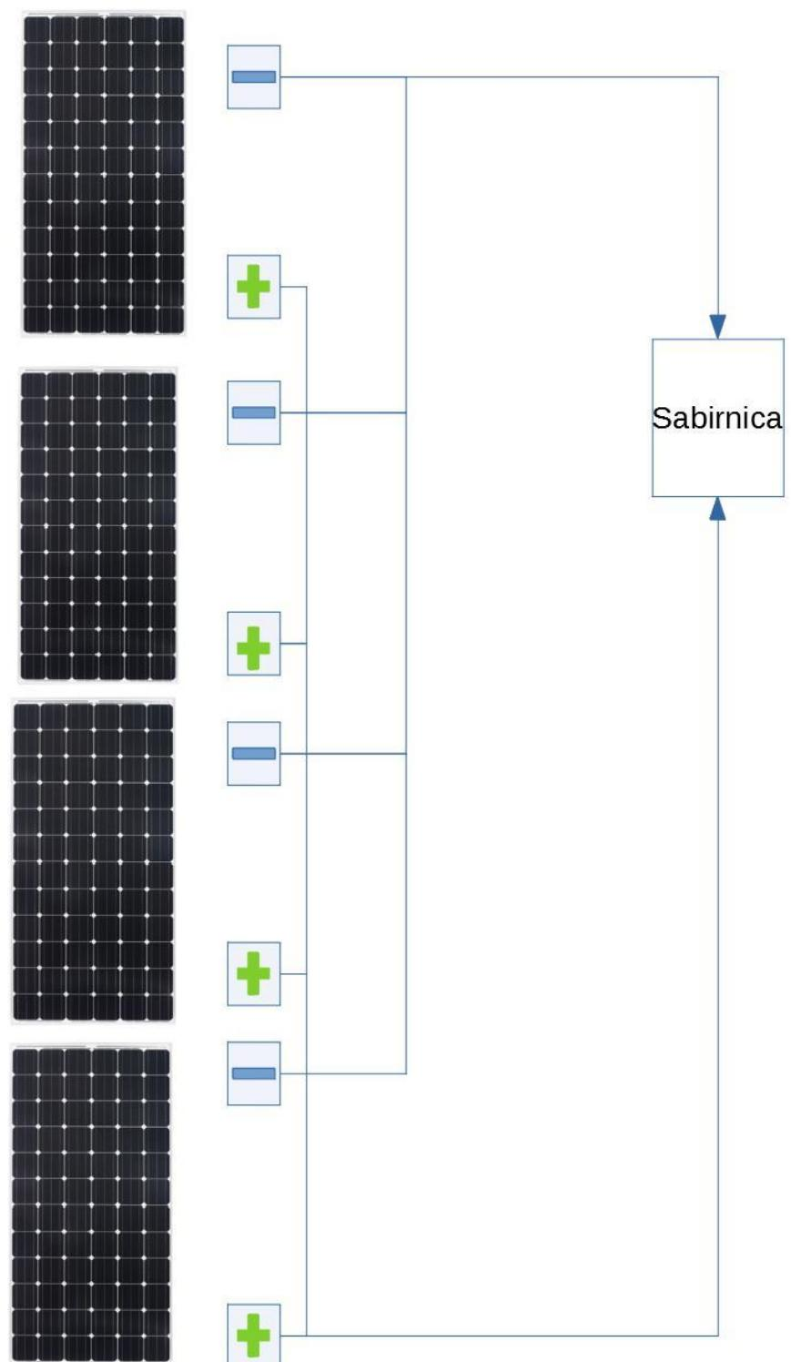
Slika 6.Paralelno spajanje fotonaponskih modula
