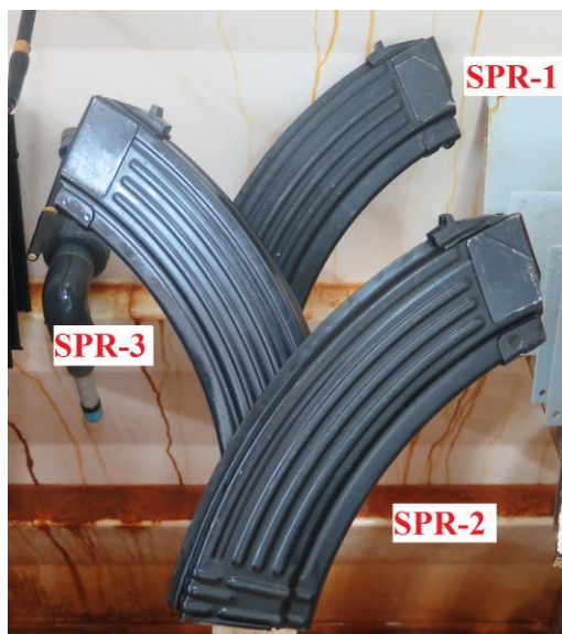
Slika 68. Uzorci SPR-1,2,3 postavljeni u slanu komoru
