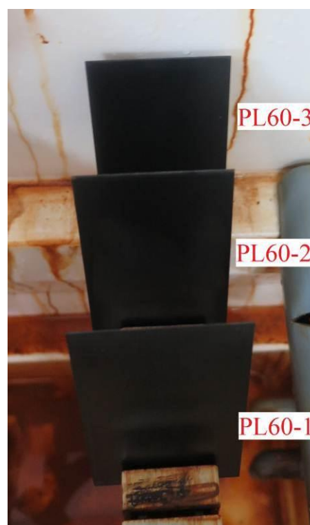
Slika 70. Uzorci PL60-1,2,3 postavljeni u slanu komoru
