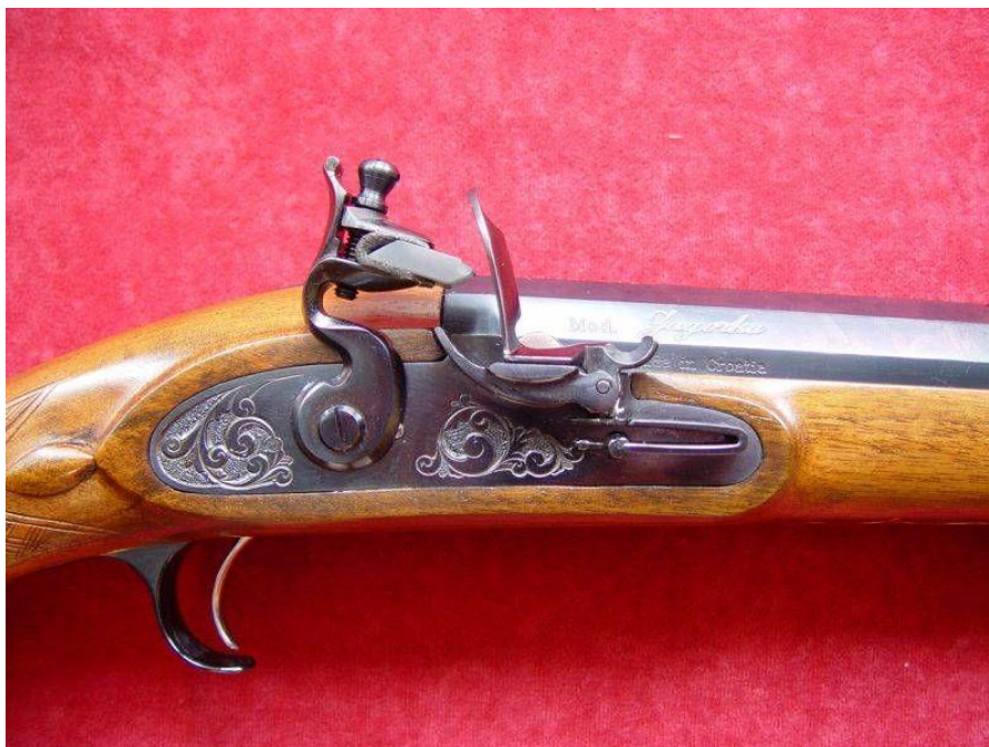
Slika 6. Mehanizam okidanja na načelu kremena [7]
