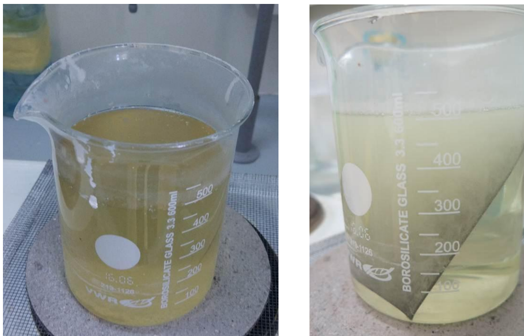
Slika 44. Otopina za bruniranje (lijevo) i provođenje postupka bruniranja (desno)
