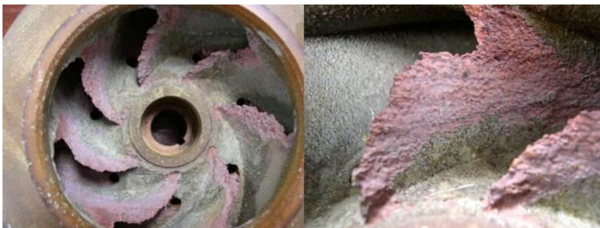
Slika 27. Oštećenja na lopaticama pumpe uzrokovana erozijskom korozijom [33]
