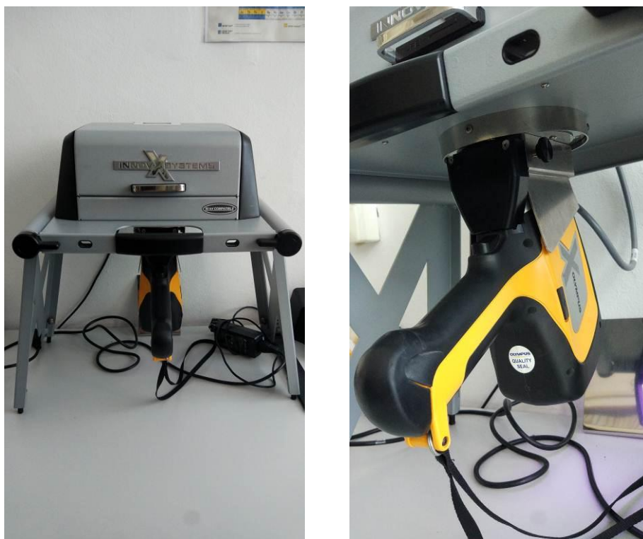
Slika 42. Postolje s uređajem Olympus Delta X
