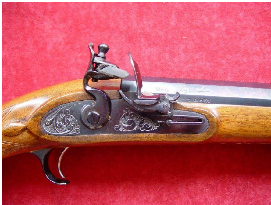
Slika 6. Mehanizam okidanja na načelu kremena [7]
