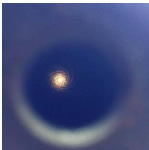
Slika 10. Žlijebovi unutar cijevi strojnice 12,7 mm
