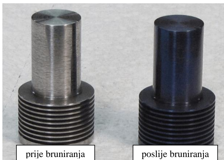
Slika 37. Prikaz konstrukcije prije bruniranja i poslije [42]
