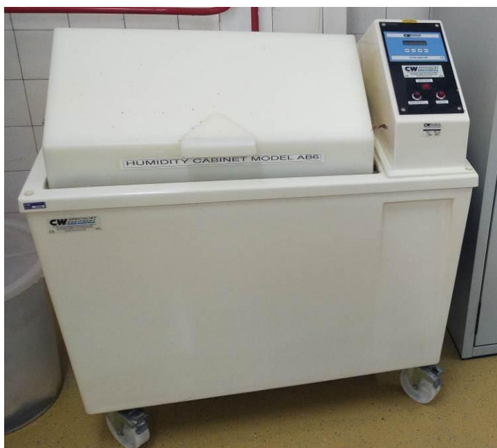
Slika 75. Vlažna komora u Laboratoriju za zaštitu materijala
