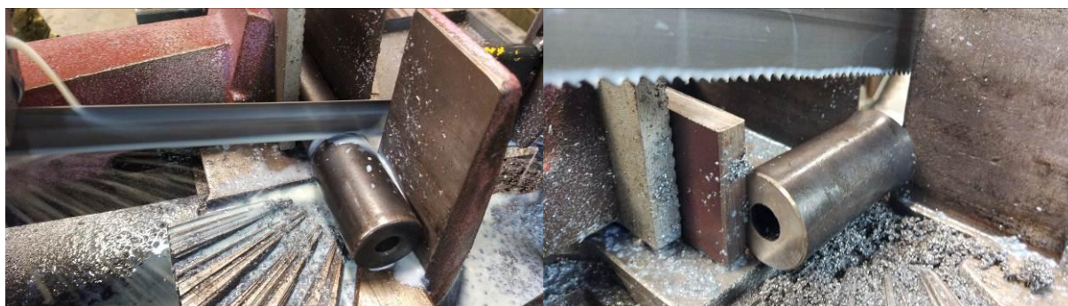
Slika 55. Izrezivanje uzoraka cijevi strojnice
