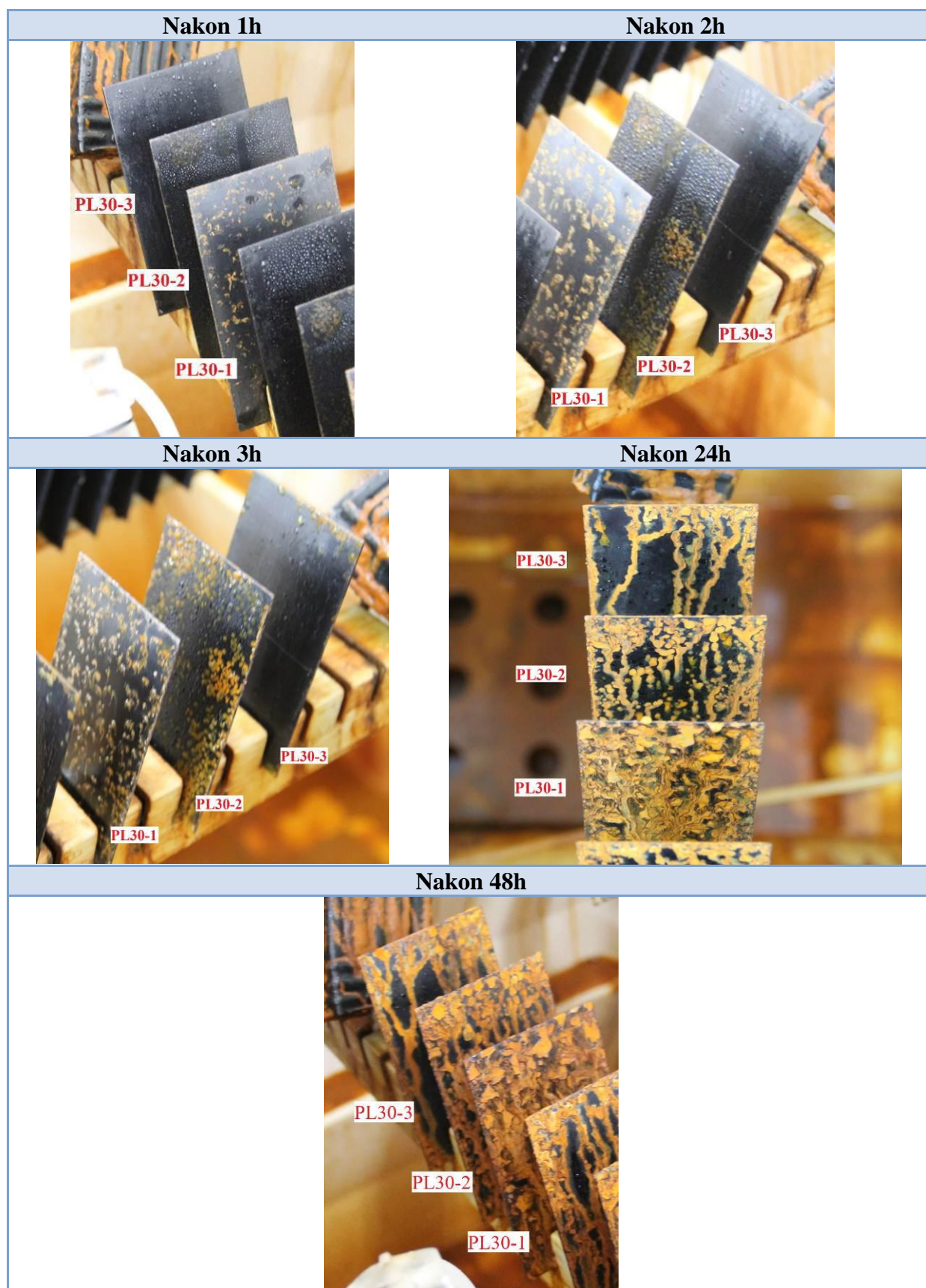
Tablica 14. Prikaz uzoraka PL30-1,2,3 tijekom ispitivanja u slanoj komori
