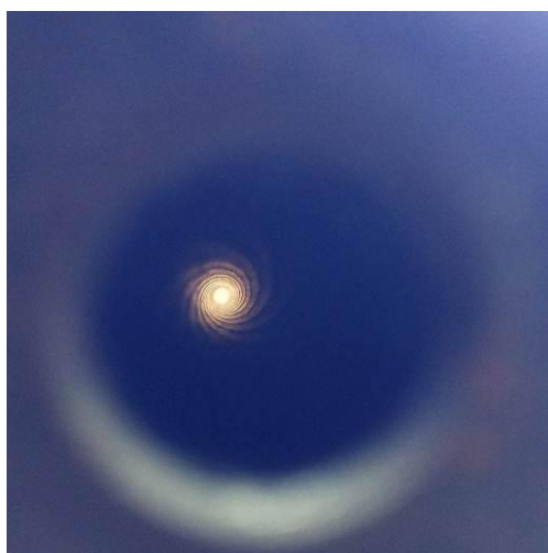
Slika 10. Žlijebovi unutar cijevi strojnice 12,7 mm
