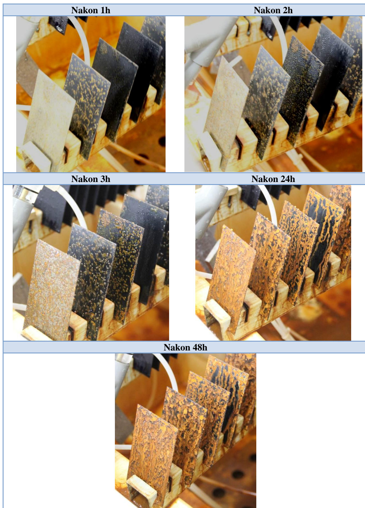
Tablica 13. Prikaz uzoraka PL0-0 i PL15-1,2,3 tijekom ispitivanja u slanoj komori
