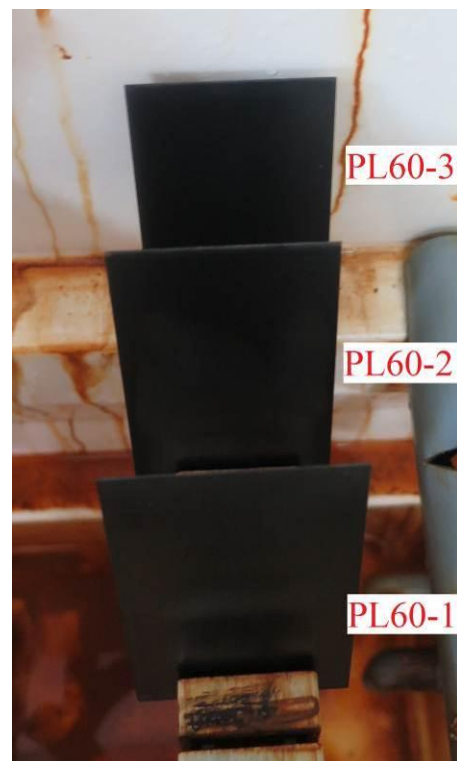
Slika 70. Uzorci PL60-1,2,3 postavljeni u slanu komoru
