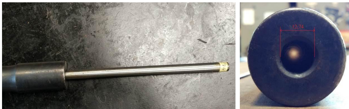
Slika 52. Mjerenje promjera cijevi etalom od 12,74 mm
