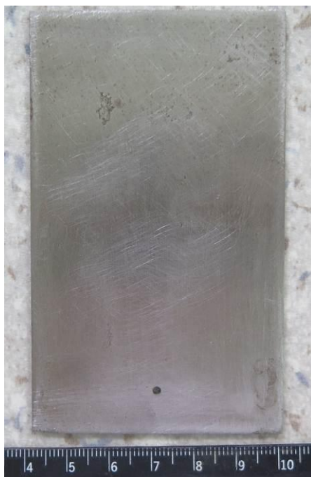
Slika 41. Uzorak nelegiranog čelika dimenzija 100 \times 50 \times 1 mm prije bruniranja
