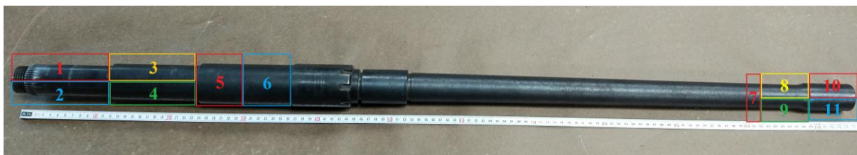
Slika 54. Shema lokacija uzoraka izrezanih iz cijevi strojnice
