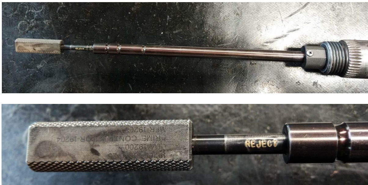
Slika 53. Mjerni instrument postavljen na početak cijevi (gore) i pokazatelj neuporabljivosti cijevi (dolje)
