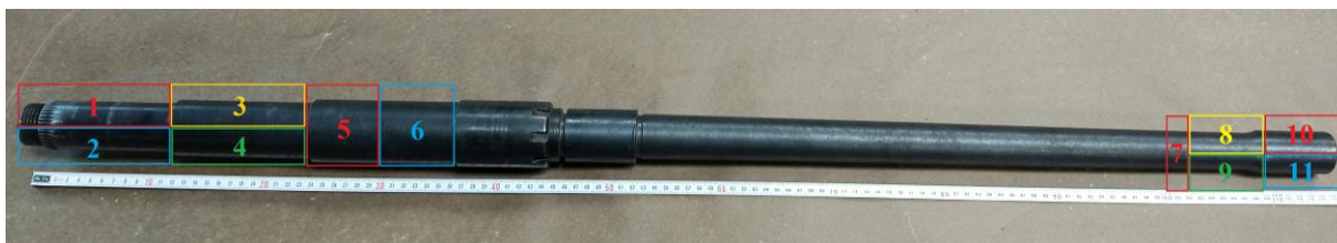
Slika 54. Shema lokacija uzoraka izrezanih iz cijevi strojnice
