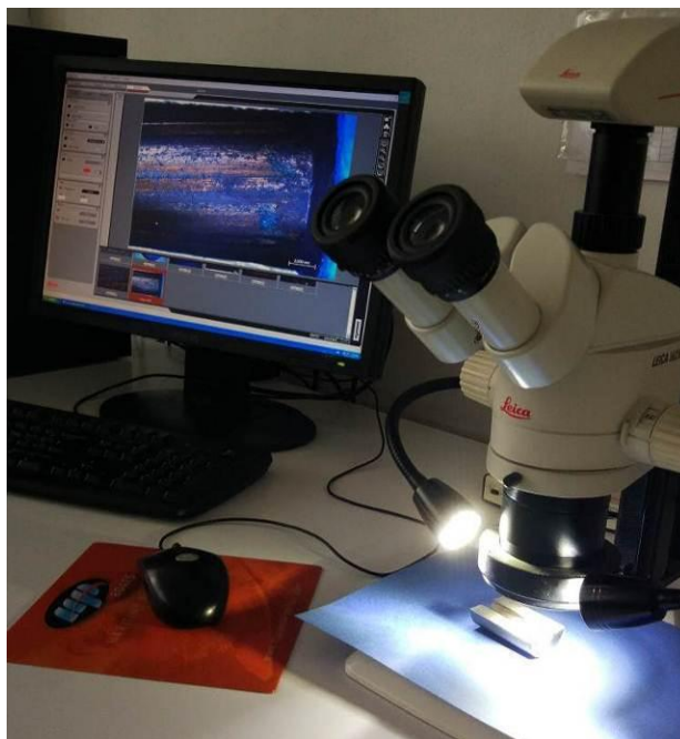
Slika 83. Stereomikroskop Leica MZ6 u Laboratoriju za zaštitu materijala
