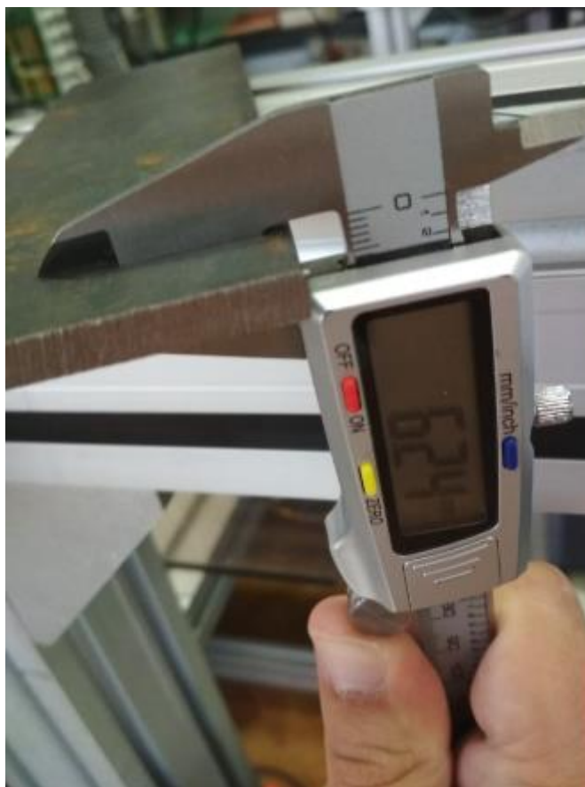
Slika 38: Mjerenje debljine predmeta snimanja
