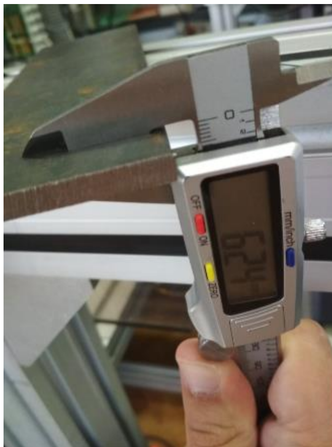
Slika 38: Mjerenje debljine predmeta snimanja
