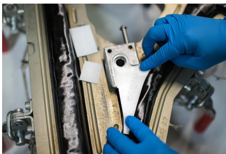
Slika 21. Slaganje slojeva prepreg -a u kalup [13]
