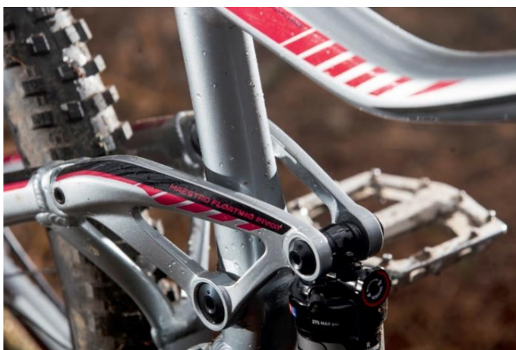
Slika 26. Tvornička izvedba klackalice iz dva dijela [16]
