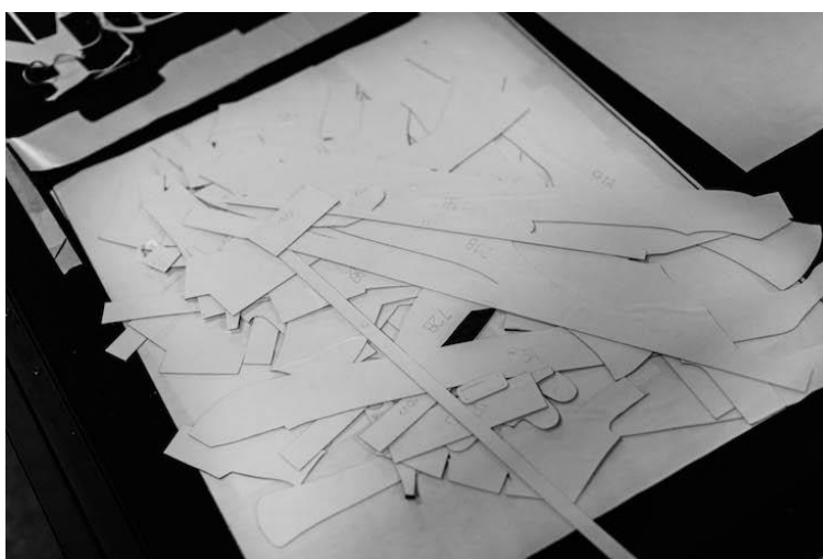
Slika 20. Različiti oblici prepreg -a potrebni za jedan okvir [13]
