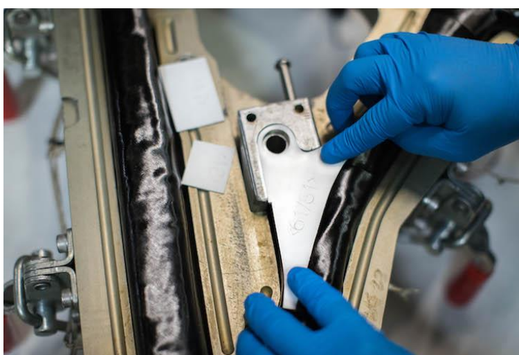
Slika 21. Slaganje slojeva prepreg-a u kalup [13]
