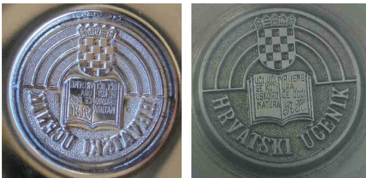
Slika 8. Žig alata prije i nakon utiskivanja geometrije master žiga i master žig [18]
