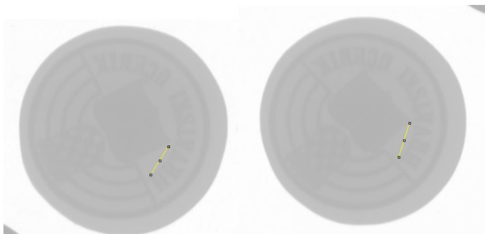
Slika 37. Homogeno područje ispitivanja označeno žutom linijom za ROI 1 (lijevo) i ROI 2 (desno)
