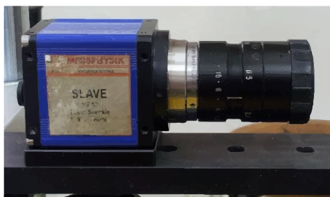
Slika 31. Videoekstenzometar / Markeri na epruveti
