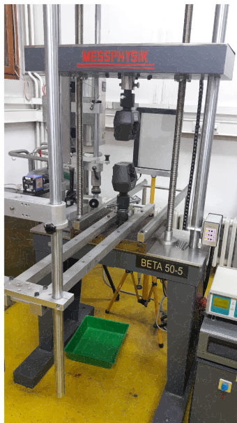
Slika 30. Kidalica Beta 50–5 (Messohysik GmbH, Austrija)
