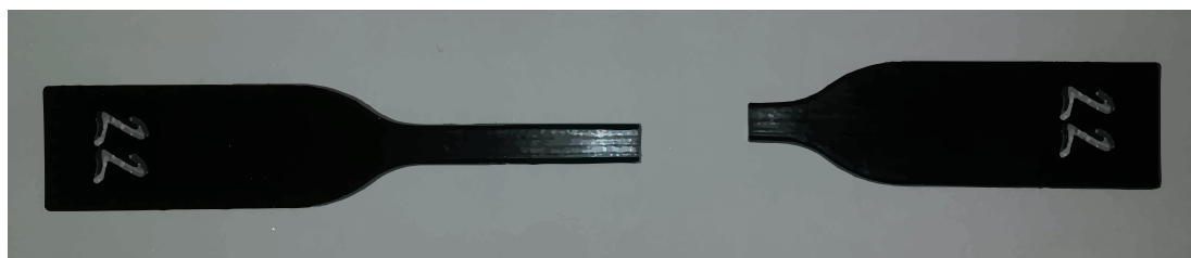
Slika 28. Prikaz ispitne epruvete nakon loma
