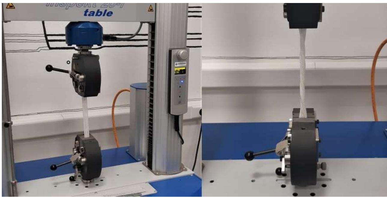
Slika 16. Ispitivanje 3 ravne i 3 uvijene niti užeta
