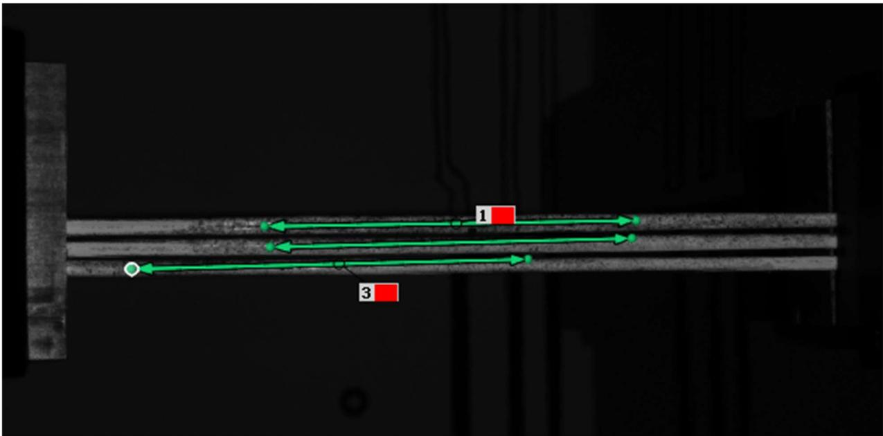
Slika 39. Ispitivanje štrika ARAMIS-om - završno stanje
