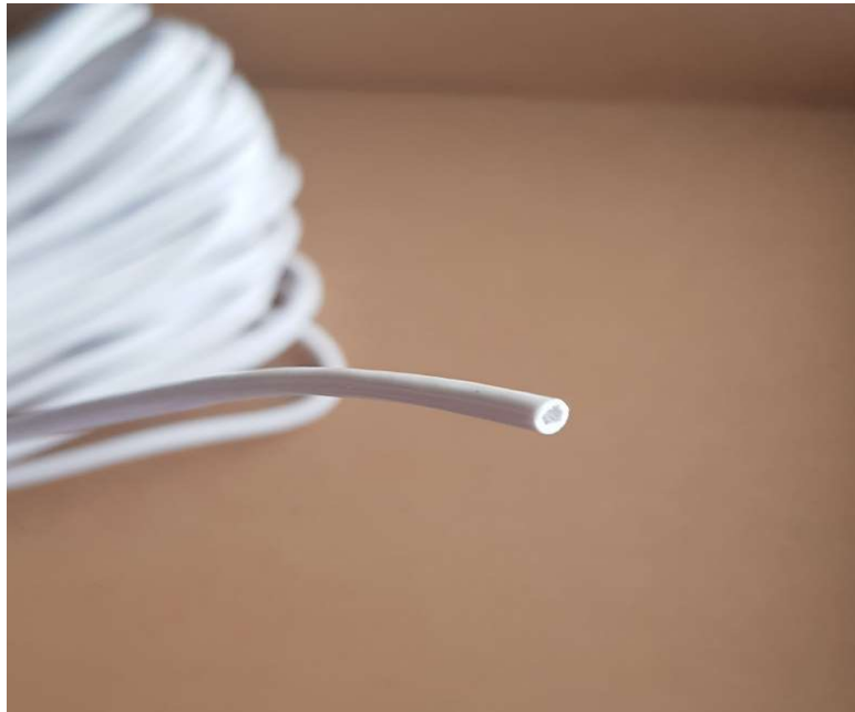
Slika 11. Uže za statičko vlačno ispitivanje
