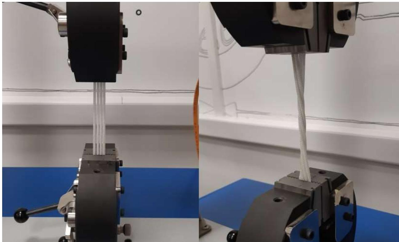
Slika 15. Ispitivanje 4 ravne i 4 uvijene niti užeta
