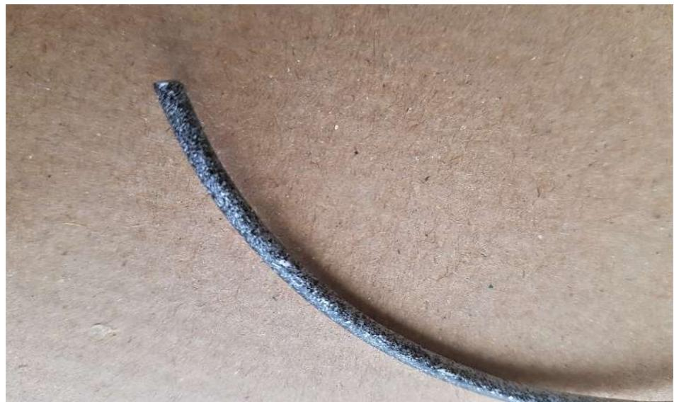
Slika 12. Stohastički premaz za ispitivanje užeta Aramis sustavom
