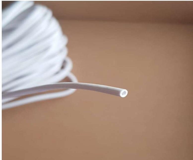
*Slika 11. Uže za statičko vlačno ispitivanje*
