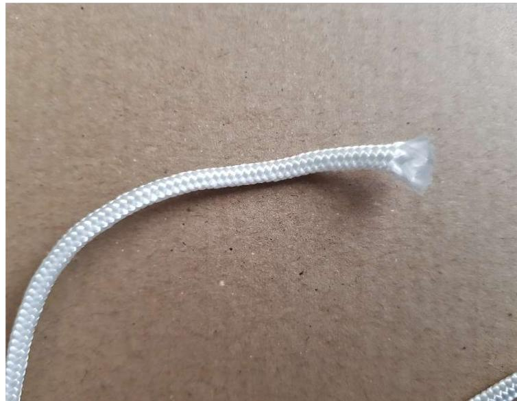
*Slika 14. Uže za staticko vlačno ispitivanje*
