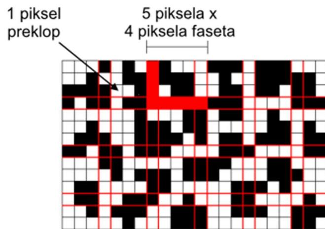
Slika 10. Pikselirani uzorak stohastičkog premaza s preklapanjem faseta u crvenoj boji [8]
