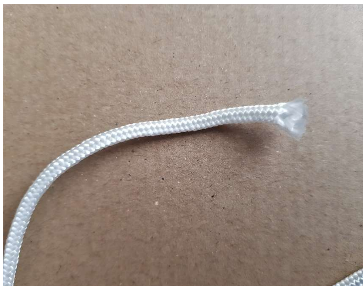
Slika 14. Uže za statičko vlačno ispitivanje
