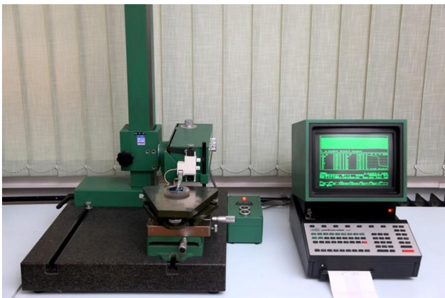
Slika 23. Perthometer S8P (Proizvođač: Feinprüf Perthen GmbH)
