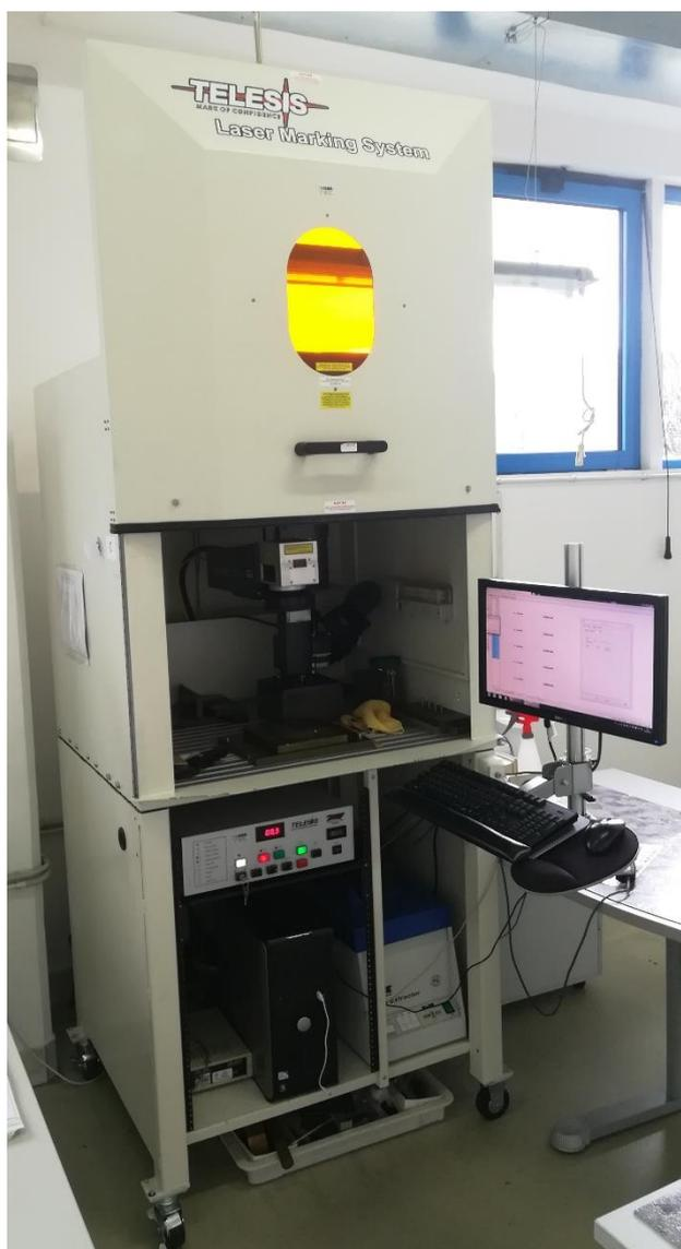
**Slika 21. Uređaj za lasersko graviranje**
