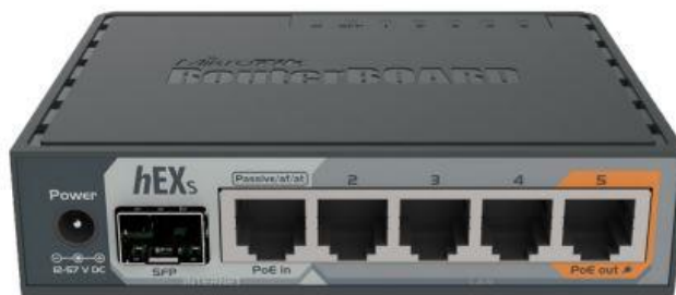
Slika 22. Ethernet priključci hEX S-a
