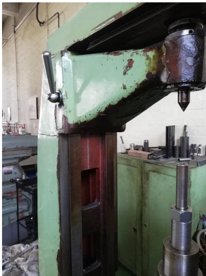
Slika 38. Prikaz stupa sa vodilicom i držačem
