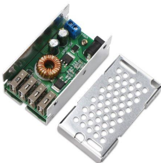
Slika 36. Prikaz regulatora napona za akvizicijski sustav i mjerno računalo [16]
