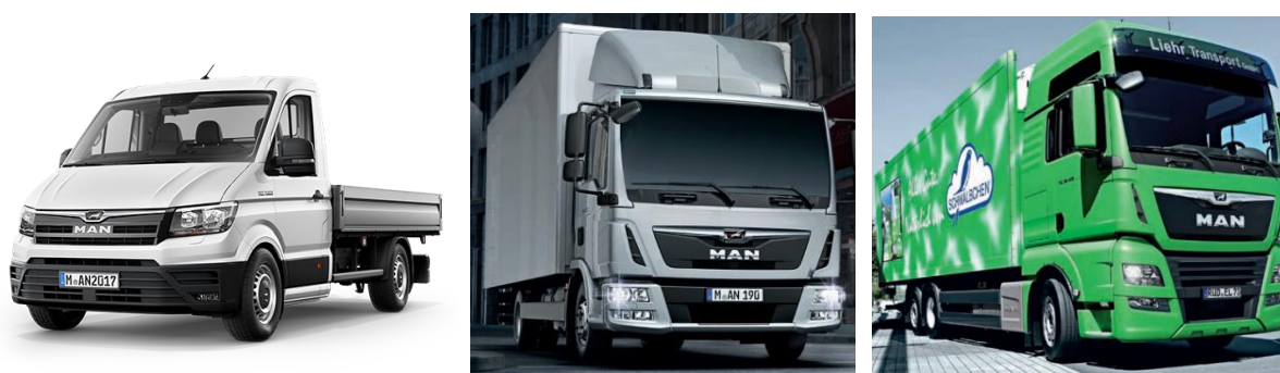
Slika 2. Primjeri teretnih vozila prema kategorijama: N1 (lijevo), N2 (sredina), N3 (desno) [3]
