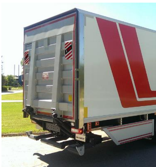
Slika 29. Utovarna platforma, konzolna [25]
