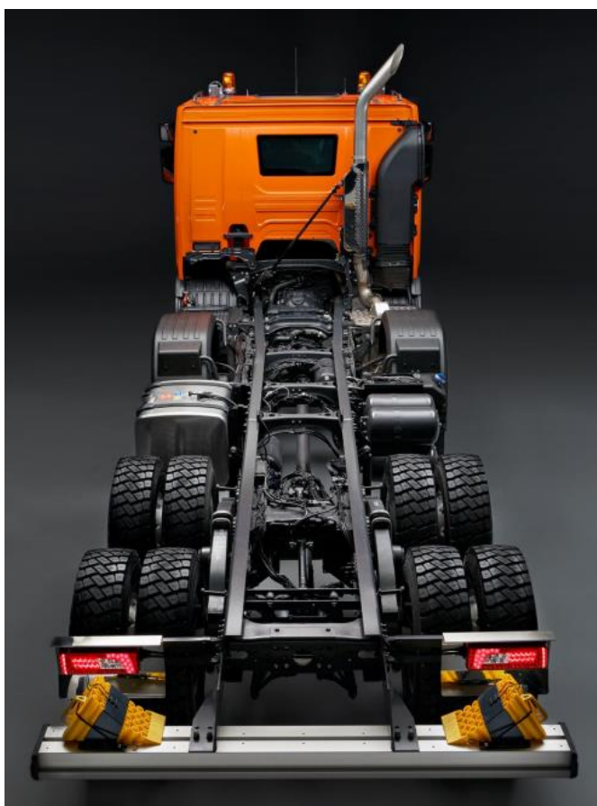
Slika 13. Teretno vozilo bez nadogradnje [14]
