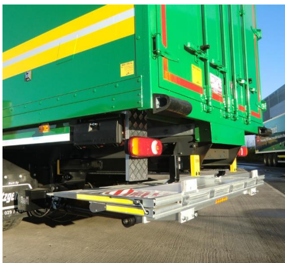
Slika 30. Utovarna platforma, sklopiva [25]
