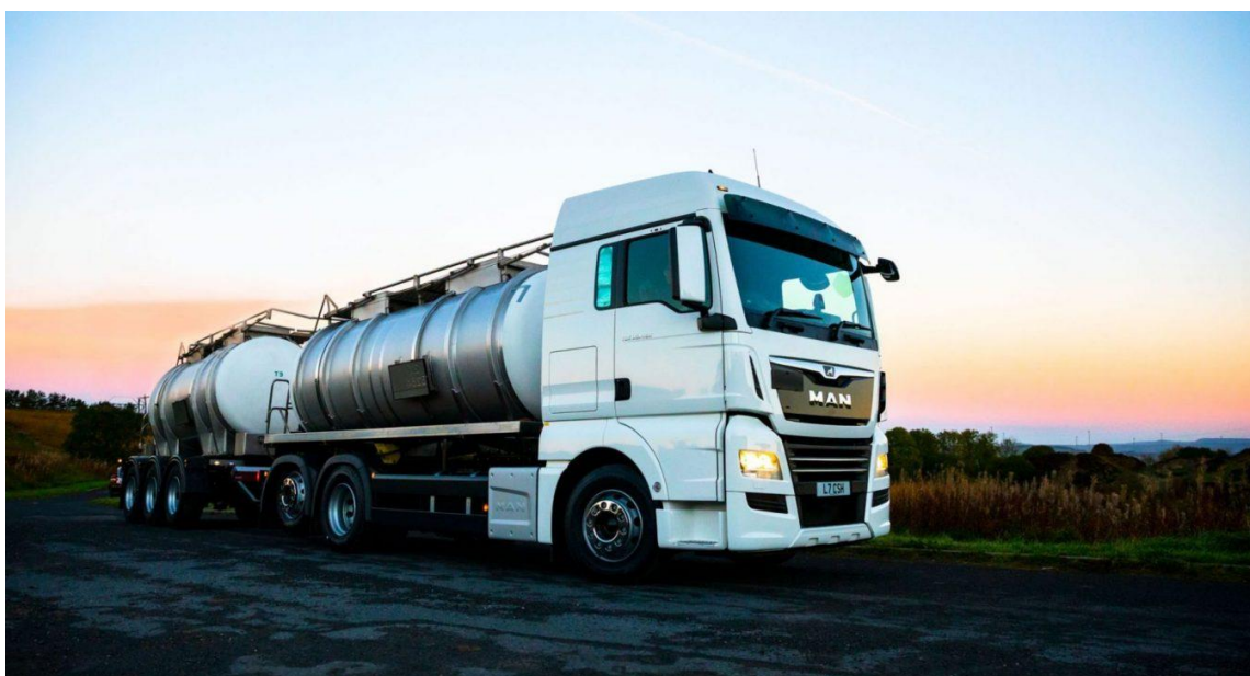
Slika 5. Nadgradnja za transport tekućeg tereta [7]
