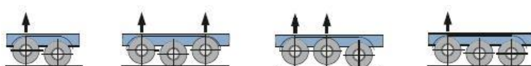
Slika 33. Opcije podizanja osovina prema [18]
