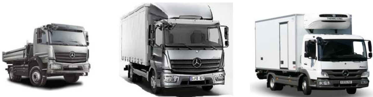
Slika 4. Vrste nadogradnje teretnih vozila [6]
