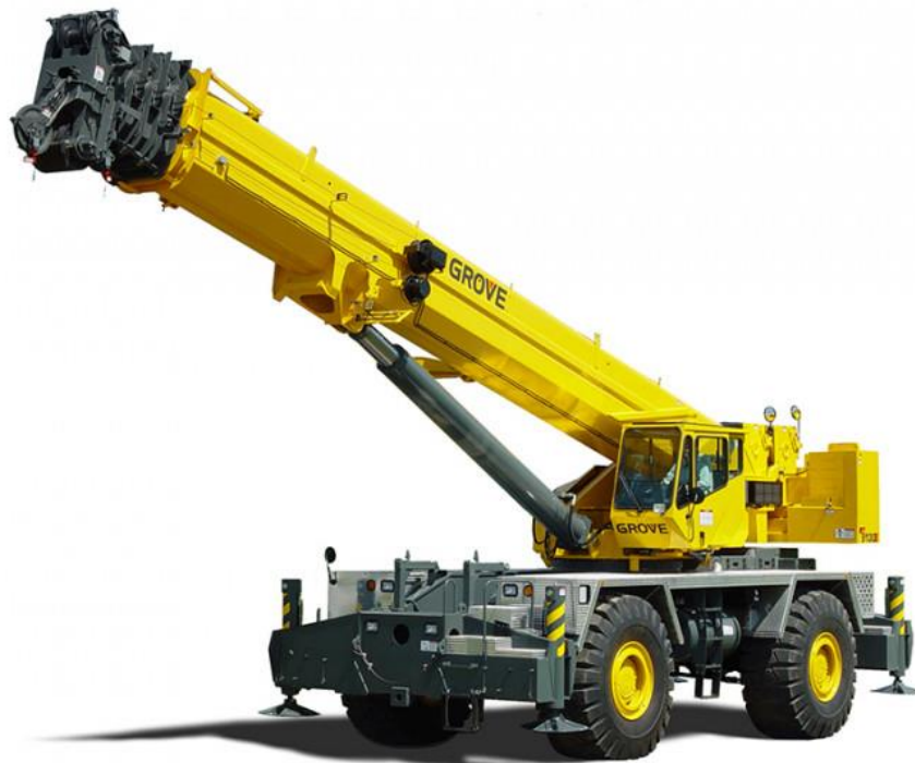
Slika 1.3. Mobilna dizalica za težak teren [5]
