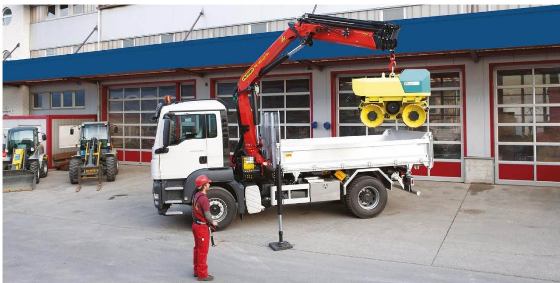
Slika 2.4. Dizalica PALFINGER PK 14502-SH A [8]
