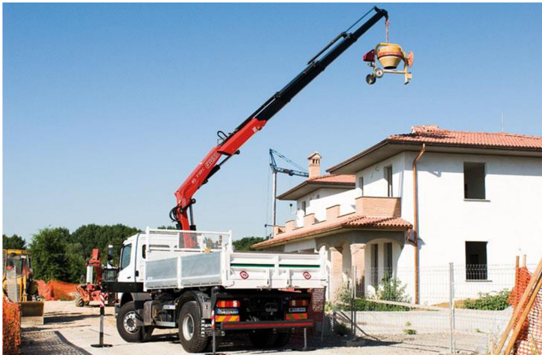
Slika 2.3. Dizalica FASSI F135A.2.22 [7]
