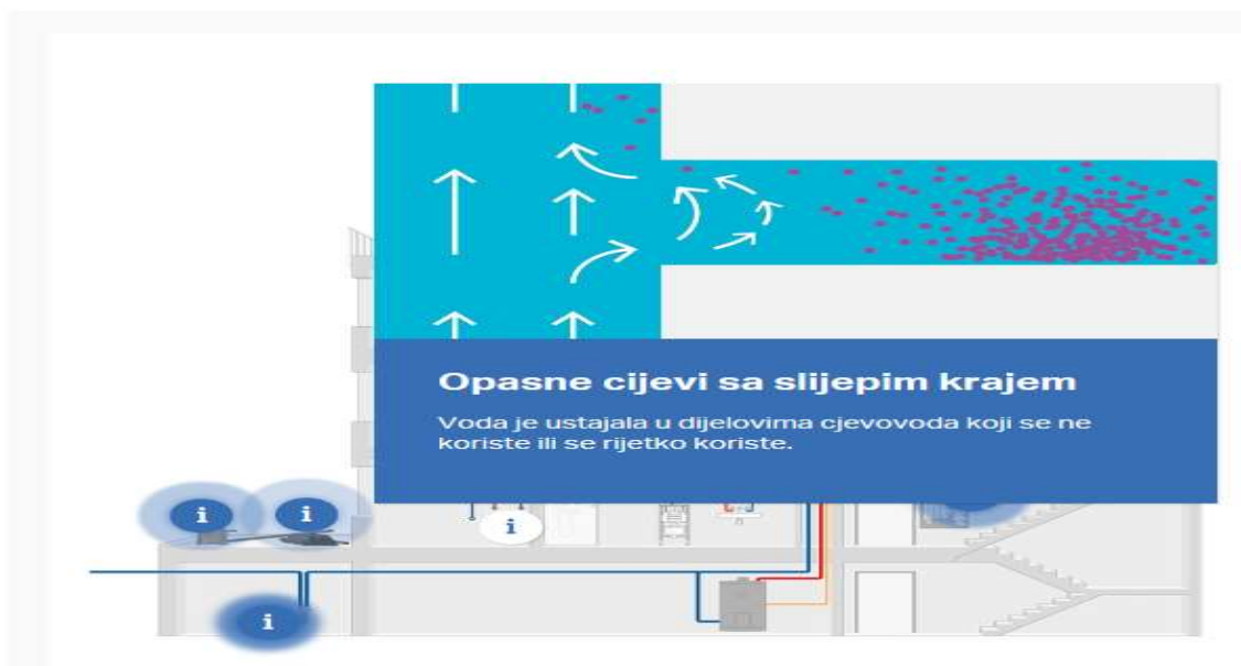
Slika 10. Mrtve zone u cijevima
