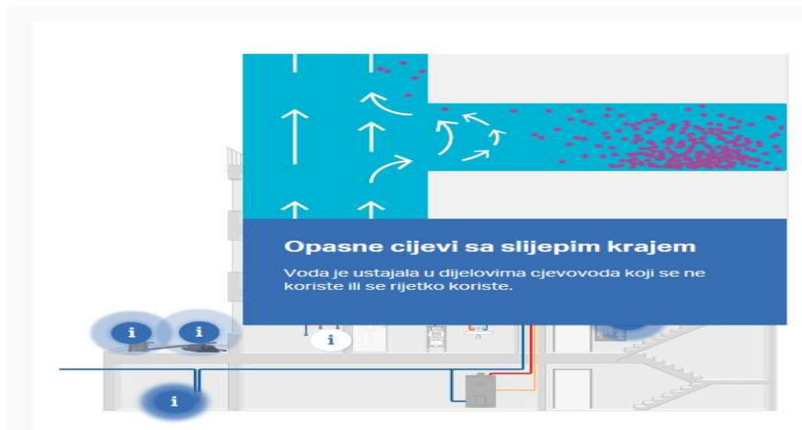
Slika 10. Mrtve zone u cijevima
