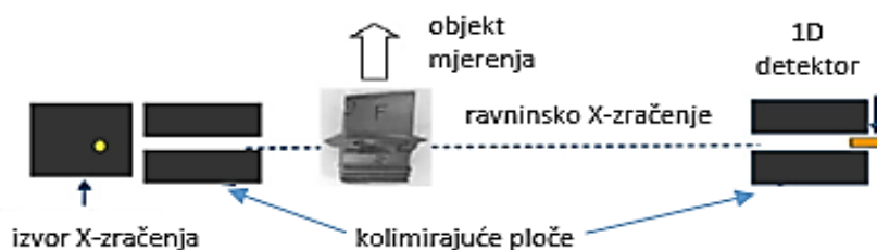
Slika 6 Princip rada linijskog CT uređaja [3]
