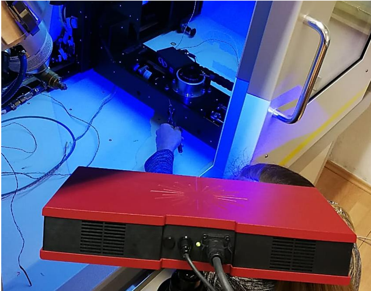
Slika 45 Proces kontaktnog 3D mjerenja manipulatora pomoću mjernog ticala
