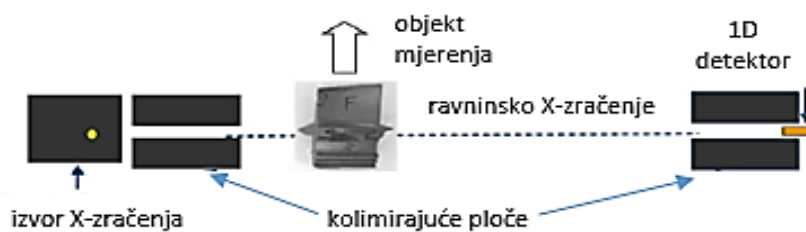
Slika 6 Princip rada linijskog CT uređaja [3]
