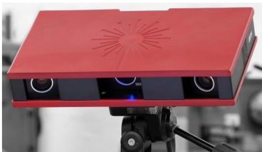
Slika 42 ATOS Core 300 sustav [17]
