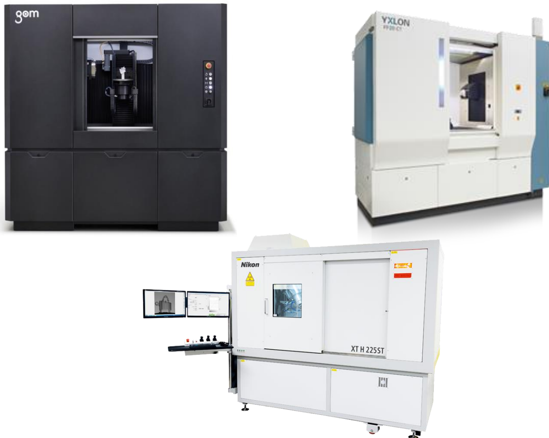
Slika 2 Primjer industrijskih CT uređaja različitih proizvođača – GOM (gore lijevo), YXLON (gore desno) i Nikon (dolje)
