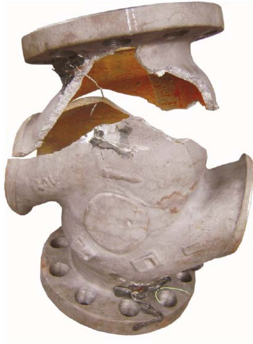
Slika 1.3. Slom kućišta ventila [3]
