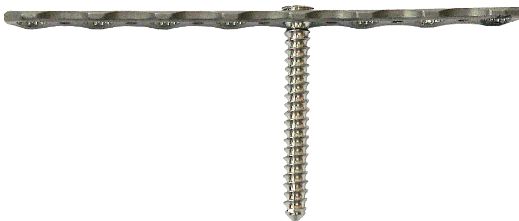
Slika 41. Pločica sa zaključanim vijkom kontrolnog sustava
