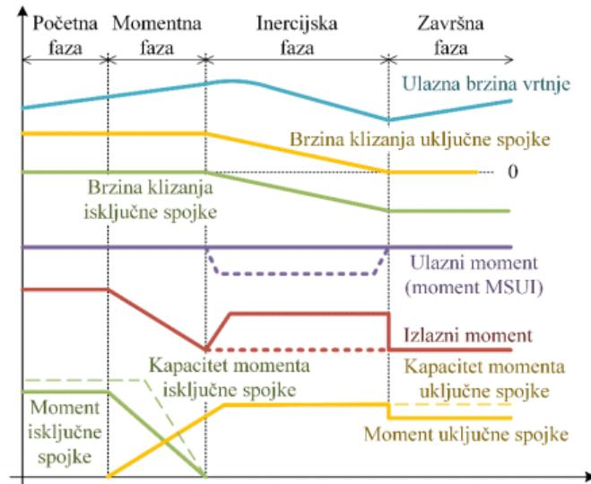
Slika 3. Karakteristične faze uzlazne promjene stupnja prijenosa s jednostrukim prijelazom
