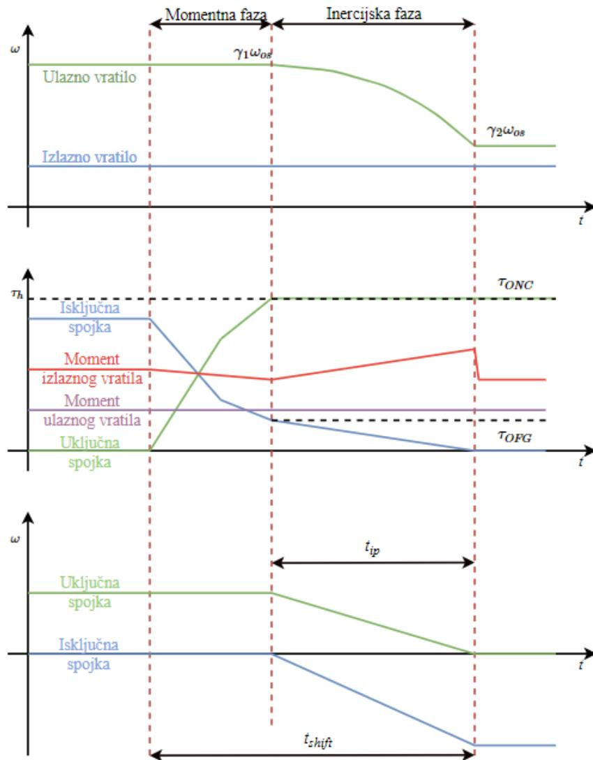
Slika 35. Ilustrativni prikaz promjene stupnja prijenosa pojednostavljenog modela s linearnim profilom isključne spojke – prvi slučaj
