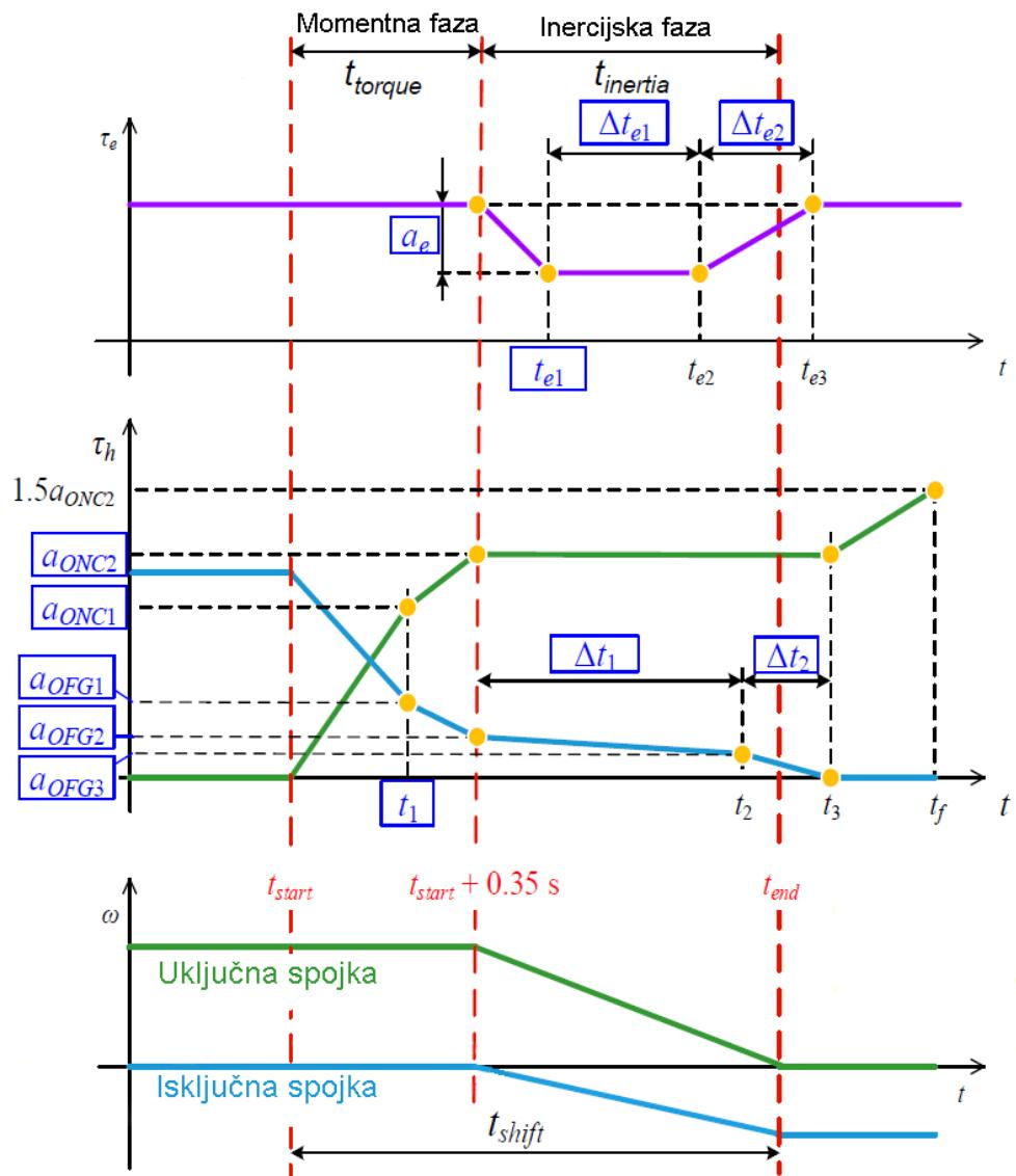
**Slika 15. Definicija po odsjećima linearnih profila kapaciteta momenata spojki i redukcije momenta motora za uzlaznu promjenu s jednostrukim prijelazom [11]**
