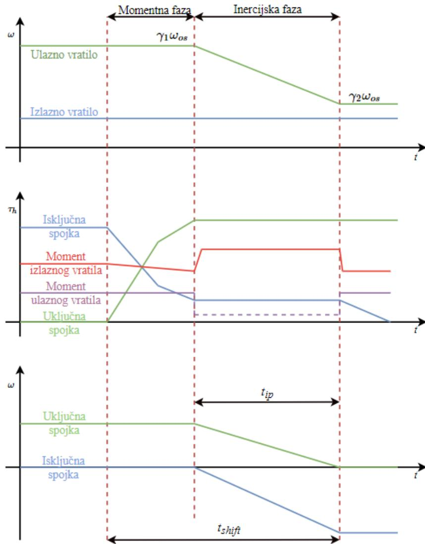
Slika 22. Ilustrativni prikaz promjene stupnja prijenosa pojednostavljenog modela
