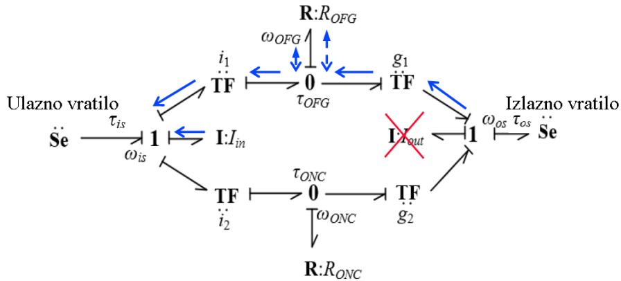
Slika 23. Vezni dijagram reduciranih modela pogona bez inercijskog sprezanja, ekvivalentan DCT mjenjaču
