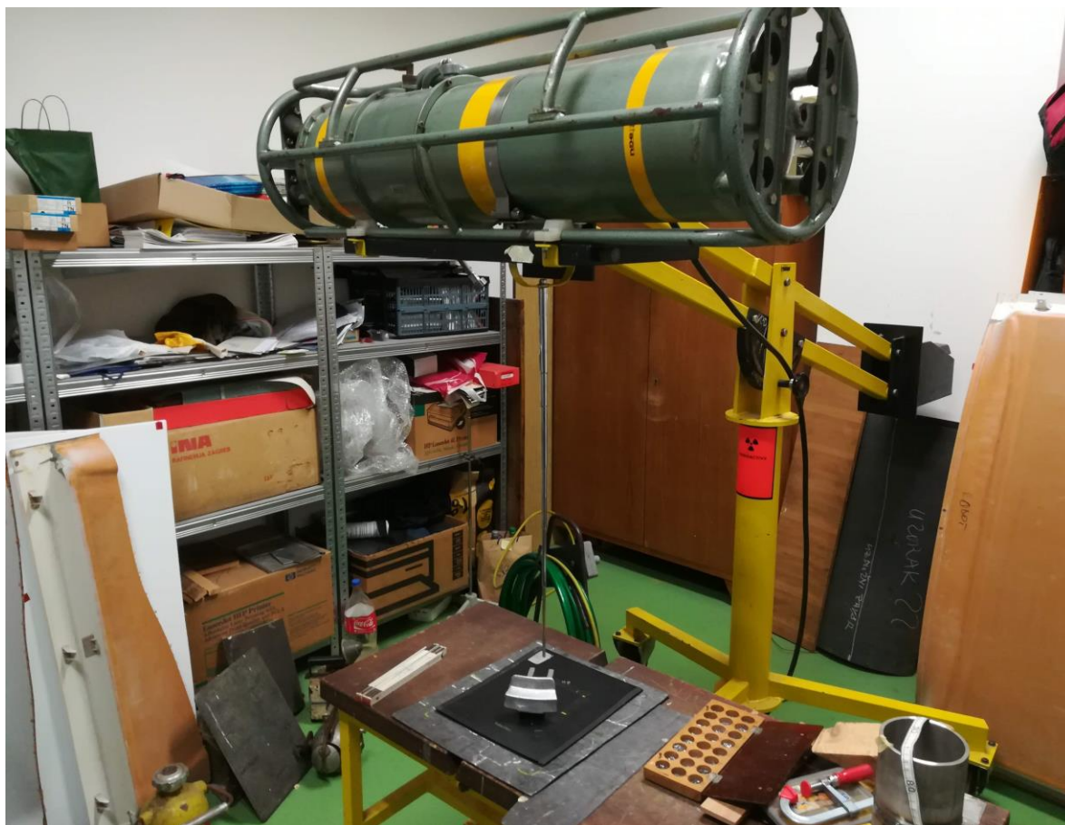
Slika 53. Odljevak na radiografskom snimanju u Laboratoriju za nerazorna ispitivanja
