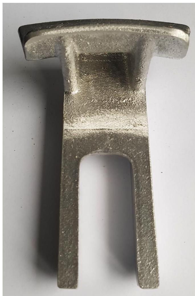
**Slika 52. Odljevak nakon uklanjanja uljevnog sustava**
