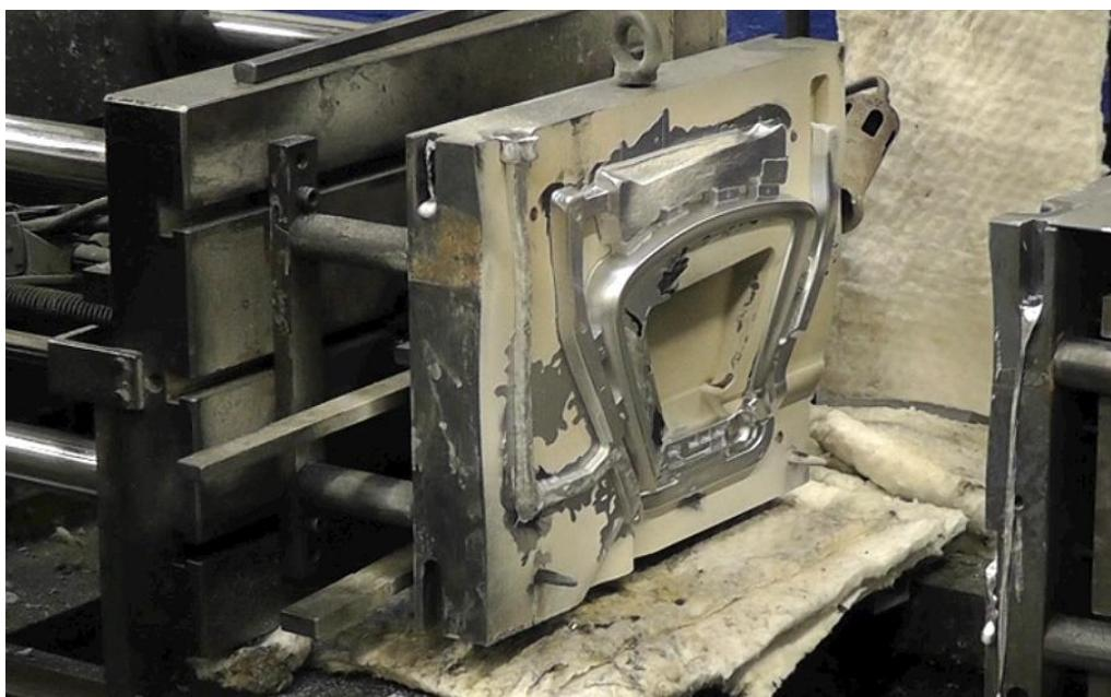
Slika 8. Kokila s pripadajućim aluminijskim odljevkom [12]
