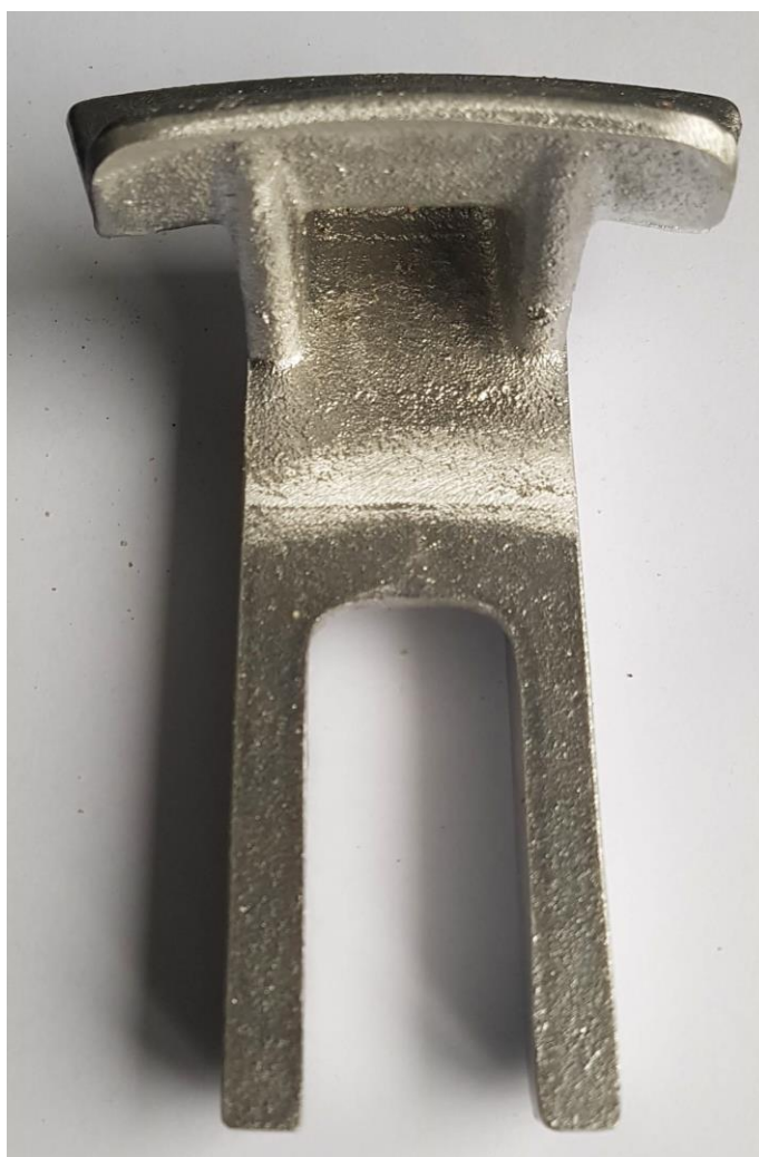
Slika 52. Odljevak nakon uklanjanja uljevnog sustava
