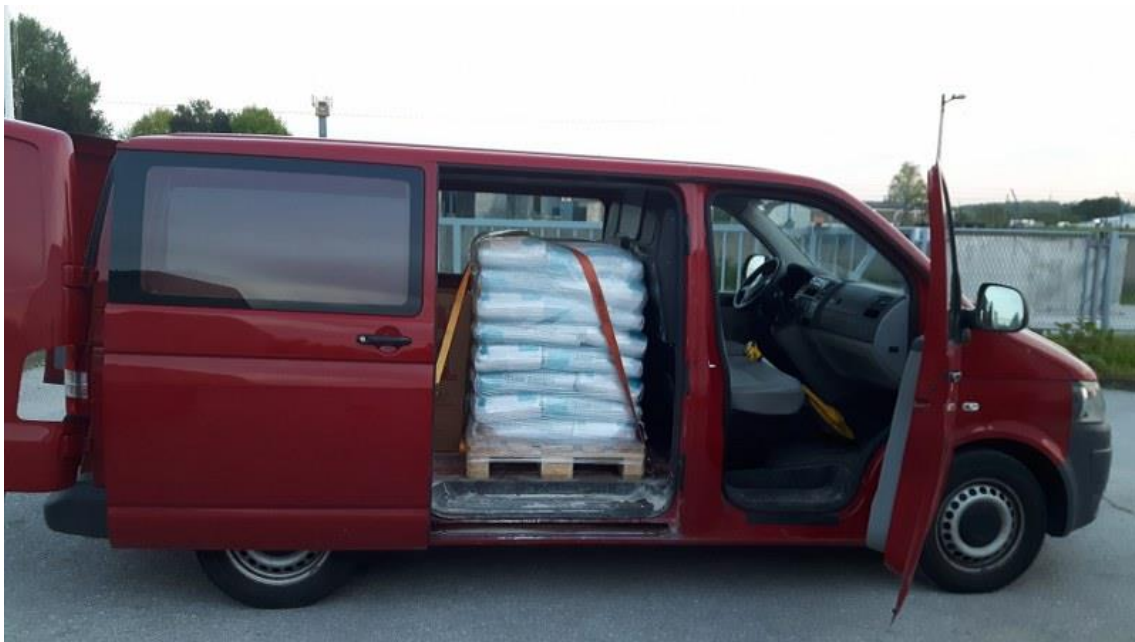
Slika 6.20 Način opterećenja automobila teretom i način učvršćenja tereta ( Q/g = 1000\text{kg} )
