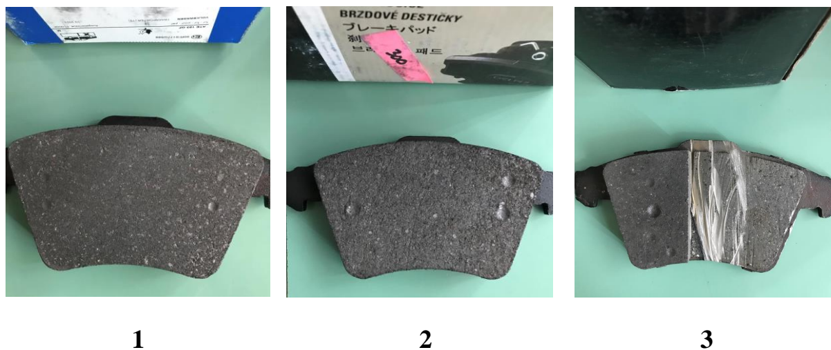
Slika 6.4 Otisci uređaja za ispitivanje tvrdoće na uzorcima
