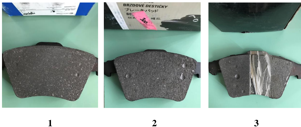
Slika 6.4 Otisci uređaja za ispitivanje tvrdoće na uzorcima
