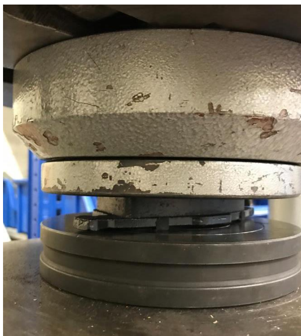
Slika 6.5 Jedan od uzoraka tijekom ispitivanja na kidalici
