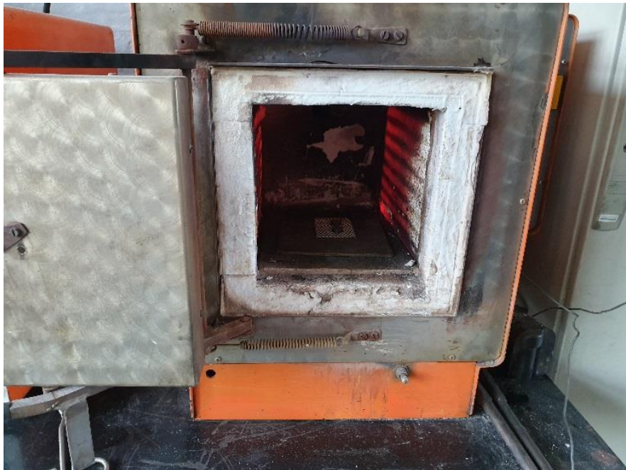
Slika 14 Peć u kojoj je provedena toplinska obrada.
