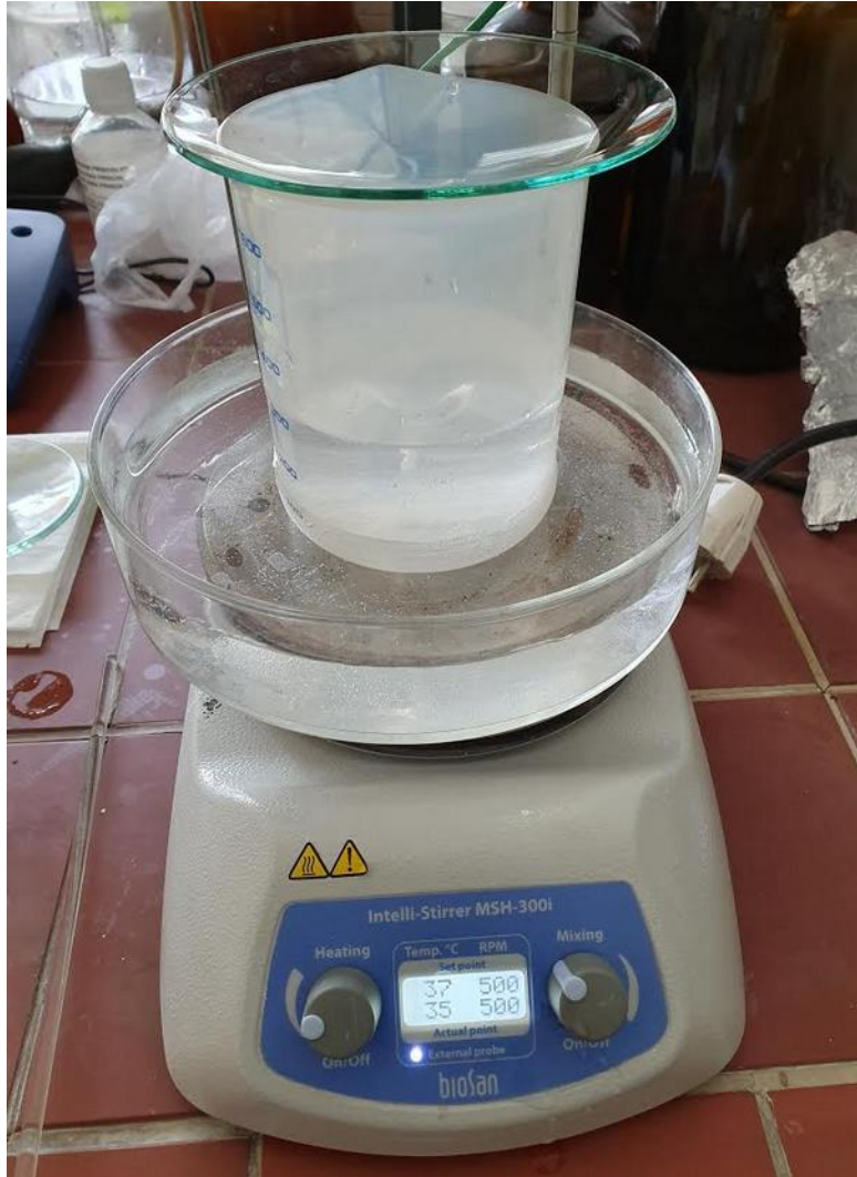
Slika 16 Fotografija magnetske miješalice tijekom zagrijavanja SBF otopine.
