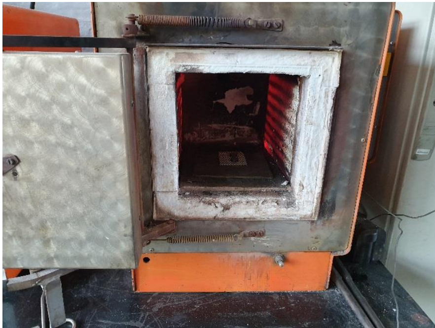
Slika 14 Peć u kojoj je provedena toplinska obrada.
