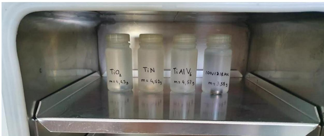
**Slika 18      Fotografija uzoraka postavljenih u peć.**
