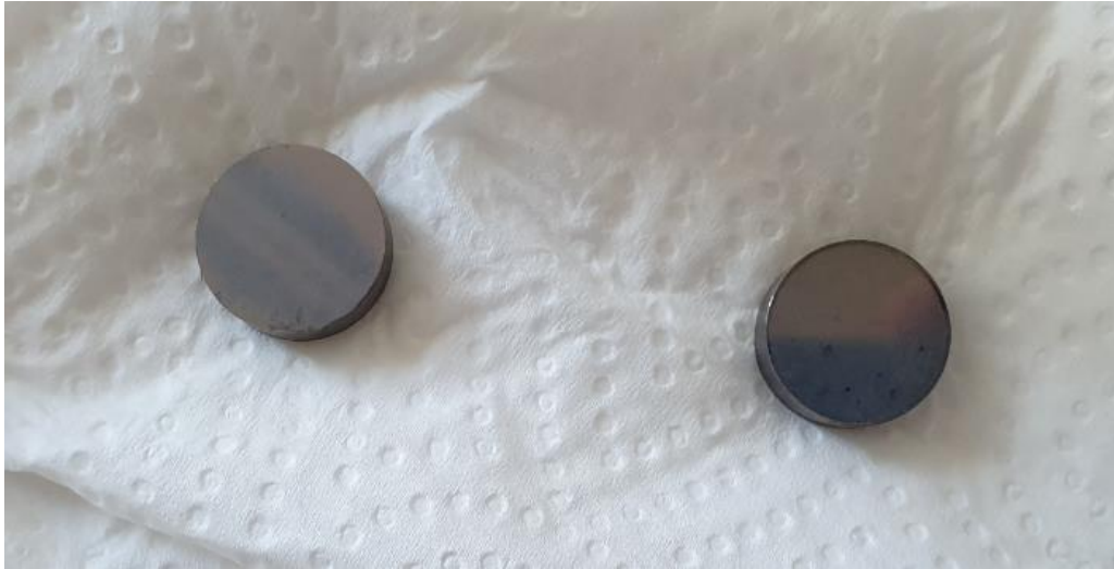
Slika 13 Uzorci nakon nagrivanja i sušenja.
