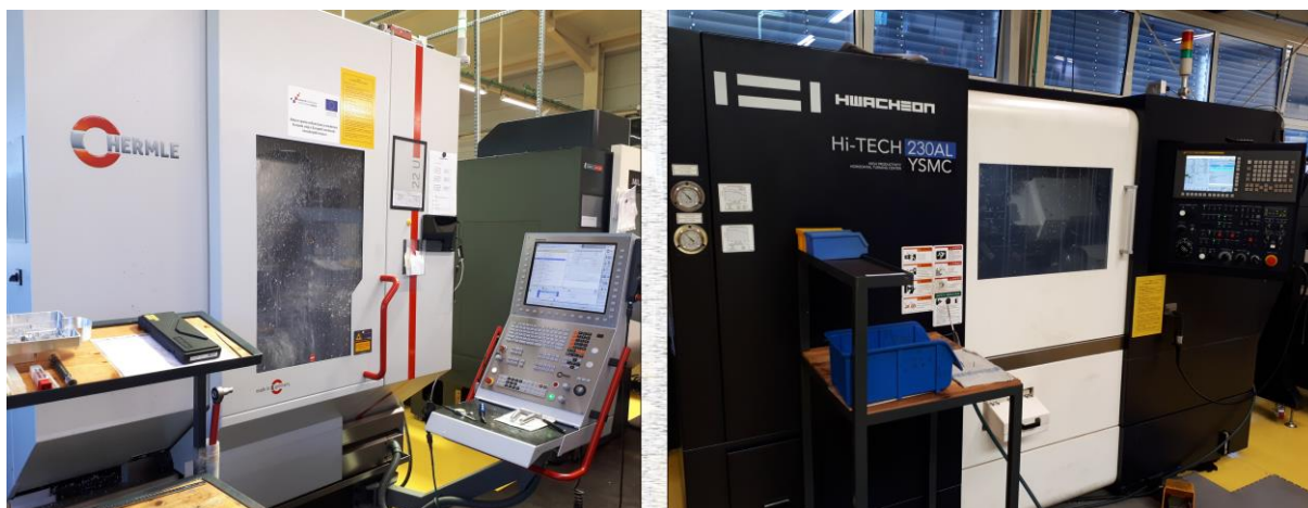
Slika 5.4. Pet-osni CNC obradni centar i šest-osna tokarilica
