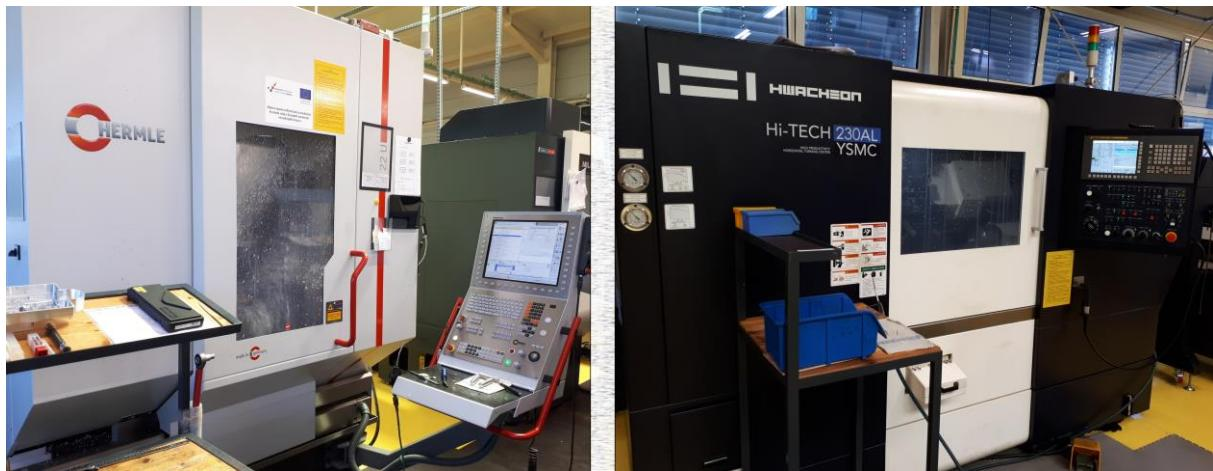
Slika 5.4. Pet-osni CNC obradni centar i šest-osna tokarilica
