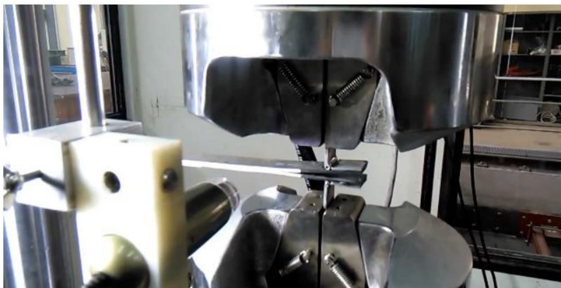
Slika 20. DCB model tijekom testiranja [11]
