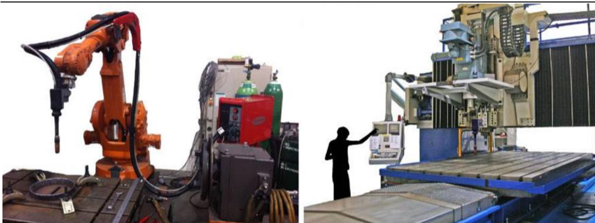
Slika 5. Strojevi za ostvarivanje gibanja pištolja [8]
