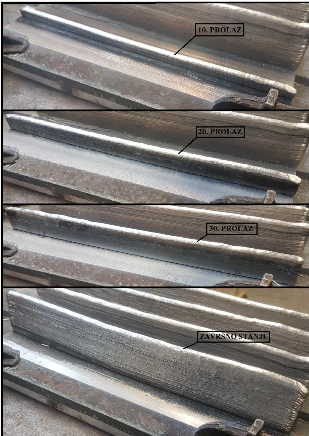
Slika 19. Prikaz postupnog nastajanja jednog od uzorka
