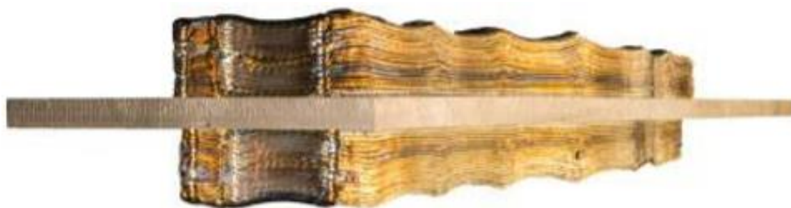
Slika 9. Način taloženja na ploču [8]
