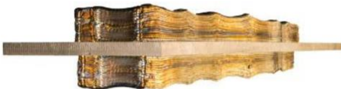
Slika 9. Način taloženja na ploču [8]
