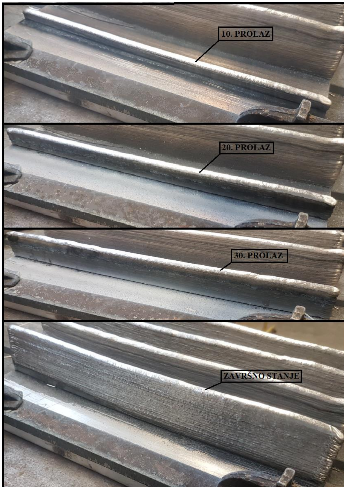
Slika 19. Prikaz postupnog nastajanja jednog od uzorka
