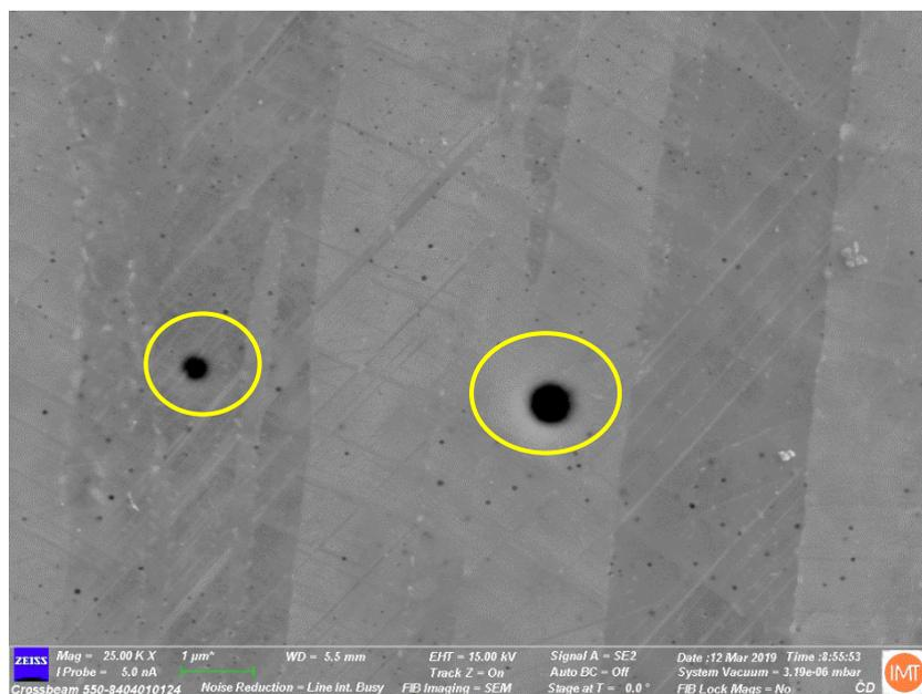
**Slika 35. Uzdužni presjek Uzorka 1 prije nanošenja keramičke prevlake, povećanje 25 000x, SEM**
