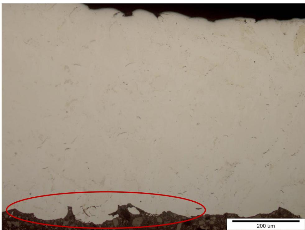
Slika 21. Poprečni presjek Uzorka 1 u poliranom stanju, povećanje 200x
