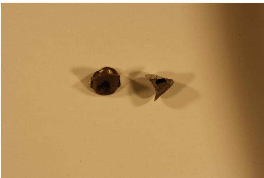
**Slika 17. Poprečni (desno) i uzdužni (lijevo) presjek Uzorka 2**
