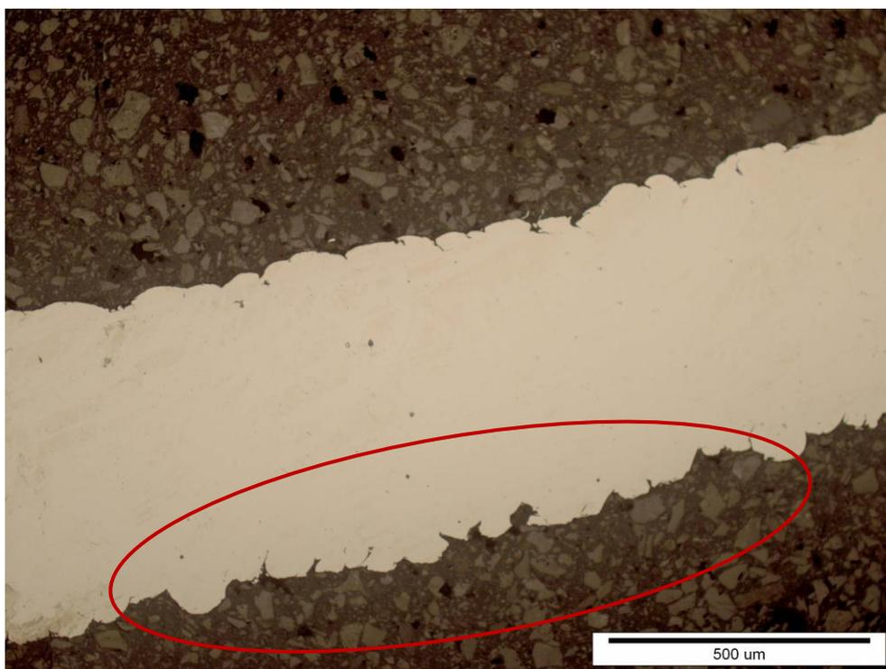
**Slika 24. Uzdužni presjek Uzorka 1 u poliranom stanju, povećanje 100x**
