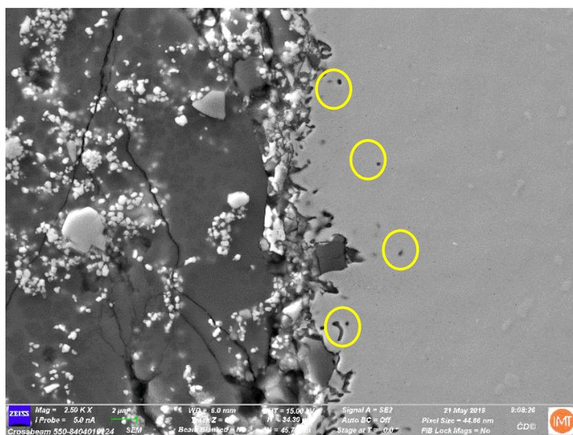
**Slika 38. Presjek Uzorka 1 nakon nanošenja keramičke prevlake, povećanje 2500x, SEM**
