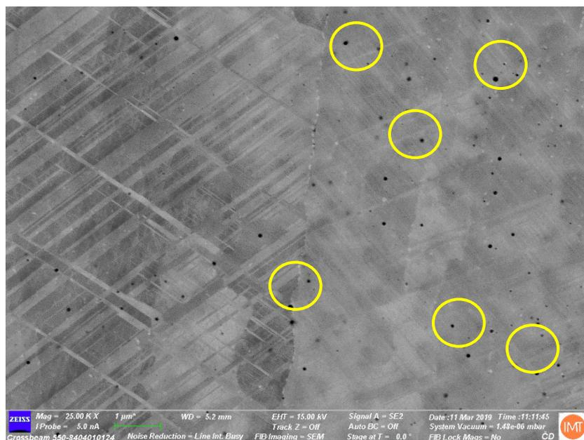
**Slika 36. Uzdužni presjek Uzorka 2 prije nanošenja keramičke prevlake, povećanje 25 000x, SEM**
