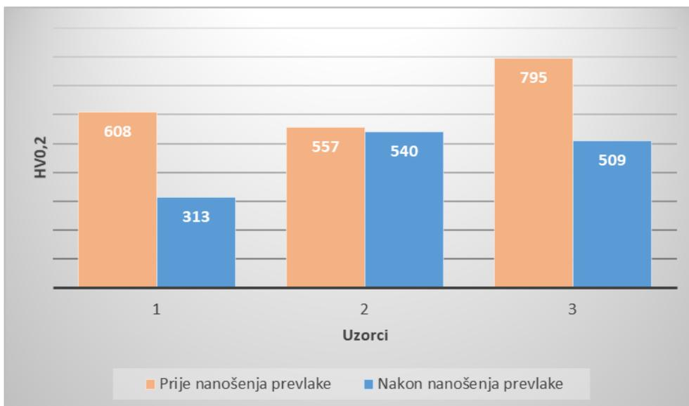
**Slika 42. Usporedba prosječnih tvrdoća uzdužnih presjeka uzoraka prije i poslije nanošenja keramičke prevlake**
