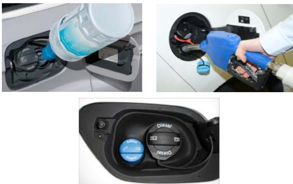
Slika 5.24. Prikaz položaja ugradnje poklopca AdBlue spremnika [23]
