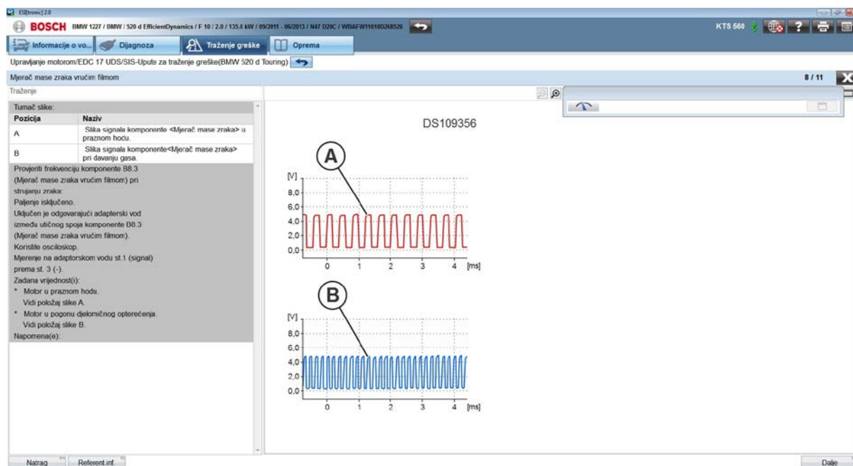
Slika 6.21. Referentni oscilogram mjerača mase zraka vozila BMW 520d prikazan u modulu traženje greške
