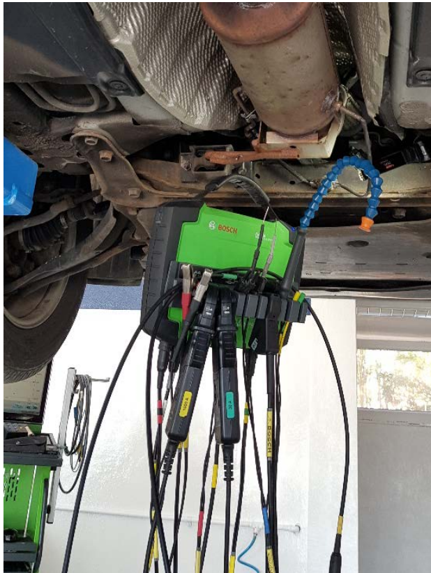
Slika 6.29. Spajanje uređaja BOSCH FSA 500
