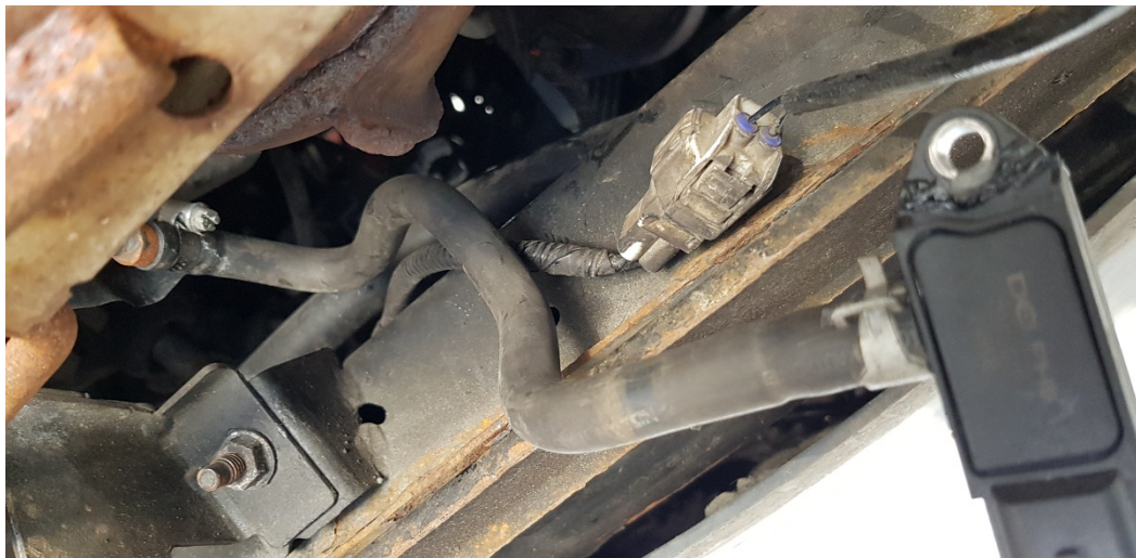
Slika 6.28. Puknuće gumenog crijeva senzora razlike tlakova ispušnih plinova
