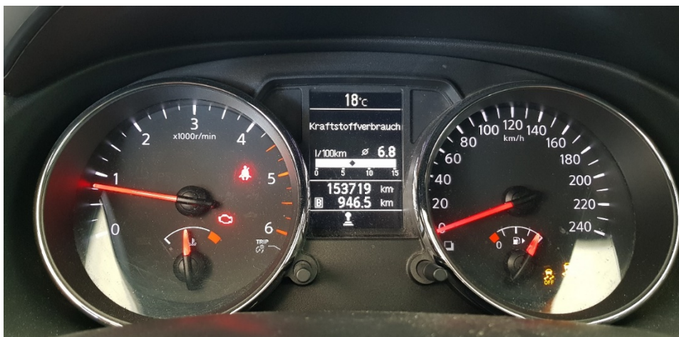
Slika 6.6. Signalizacija kvara relevantnih za ispušne plinove na instrumentalnoj ploči – Nissan Qashqai
