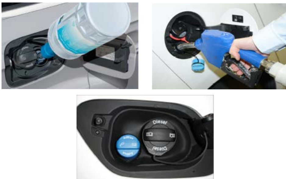
Slika 5.24. Prikaz položaja ugradnje poklopca AdBlue spremnika [23]
