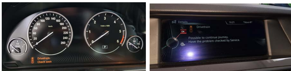
Slika 6.7. Signalizacija kvara relevantnih za ispušne plinove na instrumentalnoj ploči – BMW
