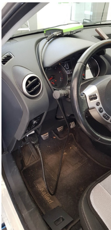
Slika 6.8. Položaj spajanja dijagnostičkog modula na vozilo
