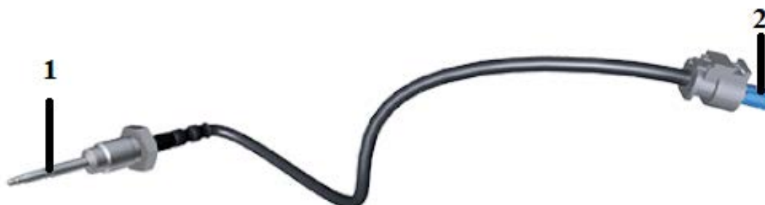
Slika 5.22. Senzor temperature ispušnih plinova [20]
