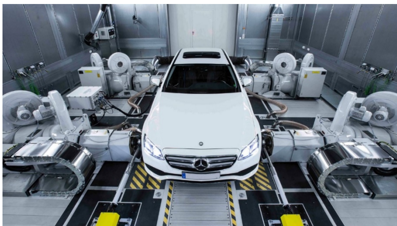
Slika 4.1. Mjerenje emisije štetnih plinova na ispitnim valjcima [17]
