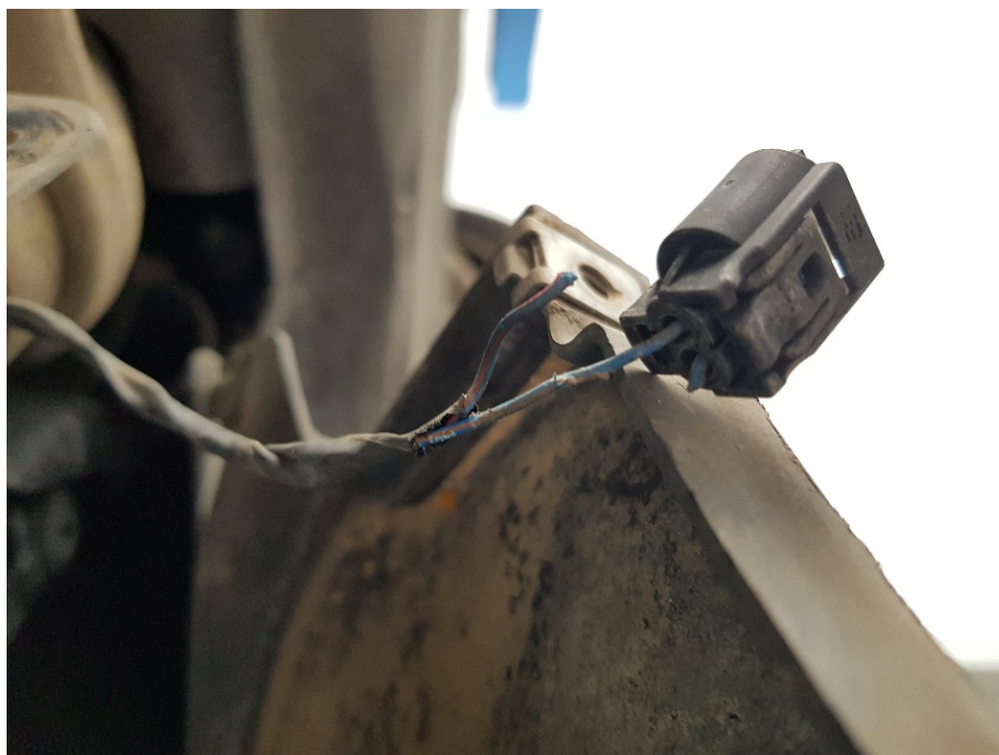
Slika 6.26. Primjer neispravne električne instalacije senzora temperature okoline Primjer neispravne električne instalacije na NO x senzora SCR sustava na vozilu BMW X5 2013. godine s oznakom E65 je prikazan na Slici 6.27.
