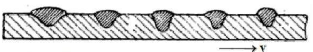
Slika 15. Shematski prikaz izgleda zavara u ovisnosti o brzini zavarivanja [24]
