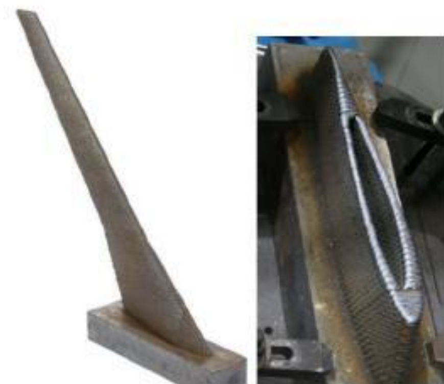
Slika 7. Krilo izrađeno WAAM postupkom od čelika visoke čvrstoće [15]
