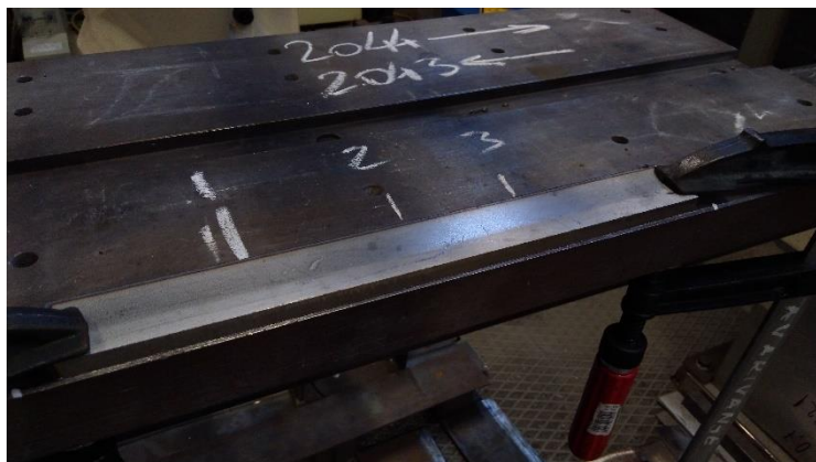
Slika 53. Oznake mjesta mjerenja visine zida
