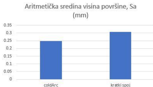
Slika 82. Usporedbi prikaz parametra aritmetičke sredine visina površine (Sa)
