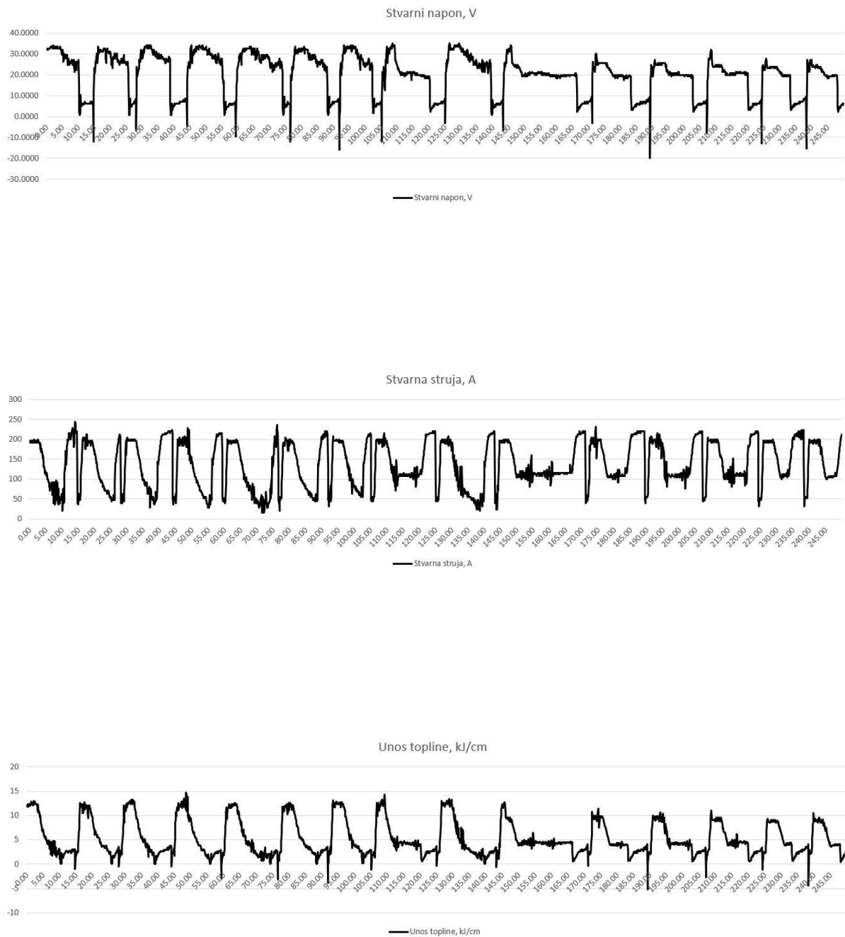
Slika 56. Promjena napona, struje u unosa topline tijekom vremenskog intervala – prolaz 30
