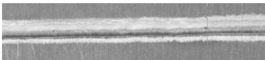
Slika 28. Lim AlMg3; kutni spoj na preklopnom spoju; 1,0 mm AlSi5 dodatni materijal 1,2 m/min; U = 13 V; I = 55 A [30]
