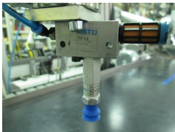
Slika 10. Vakuum sisaljka na FESTO vakuum generatoru.
