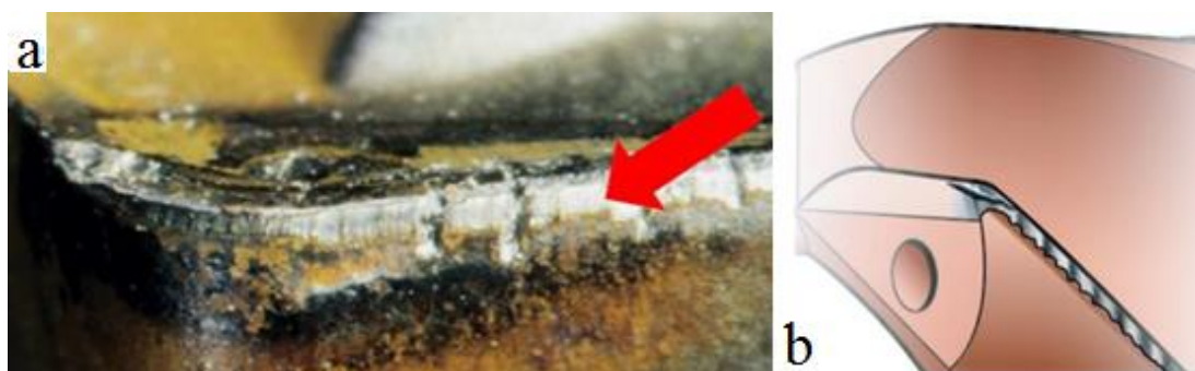
Slika 20. Toplinska napuknuća a) prema [25], b) prema [12]
