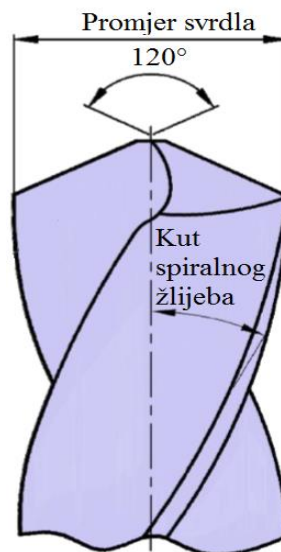
Slika 3. Geometrija spiralnog svrdla [5]
