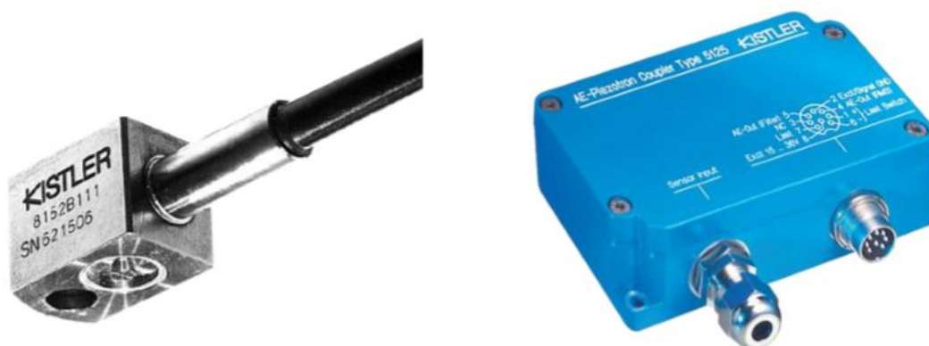
Slika 46. Senzor akustične emisije i pripadajući sklop za prihvata signala akustične emisije [33]
