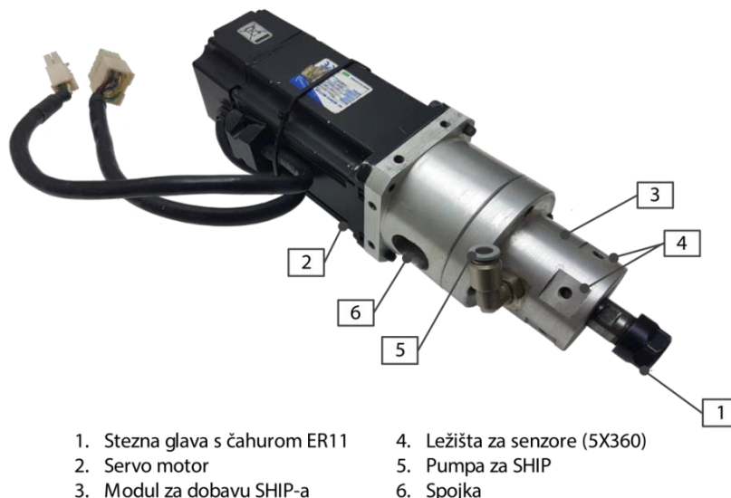
Slika 41. Modul glavnog prigona [5]
