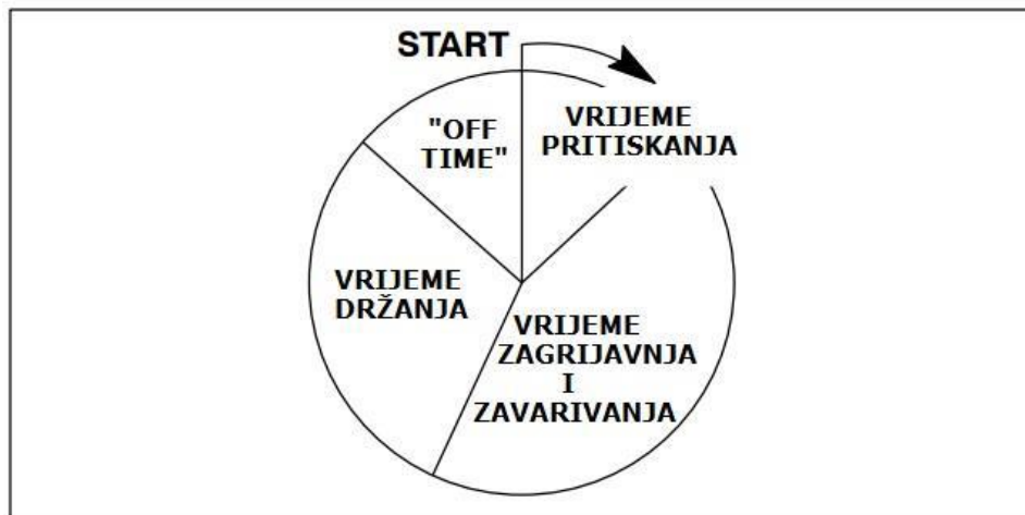
Slika 15. Vremenski ciklusi pri elektrotopnom zavarivanju[16]
