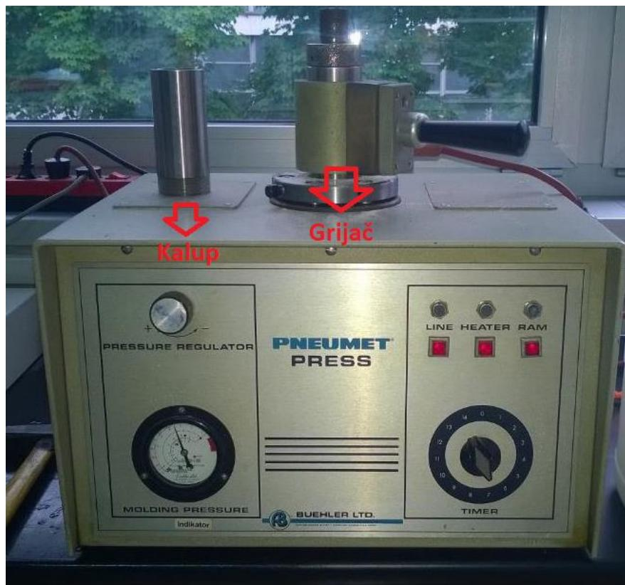
Slika 26. Pneumatska preša Buehler Pneumet Press
