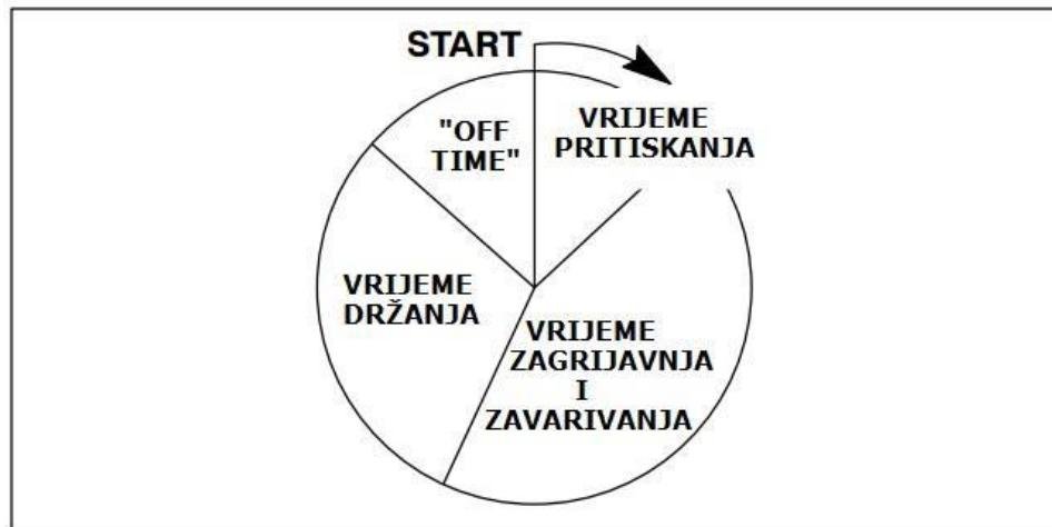
**Slika 15. Vremenski ciklusi pri elektrootpornom zavarivanju[16]**
