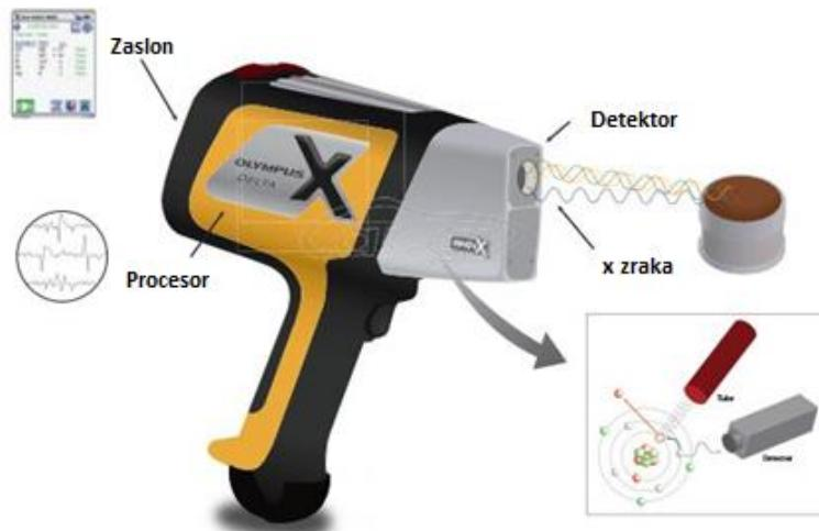
Slika 22. Olympus XRF Analyzer[120]
