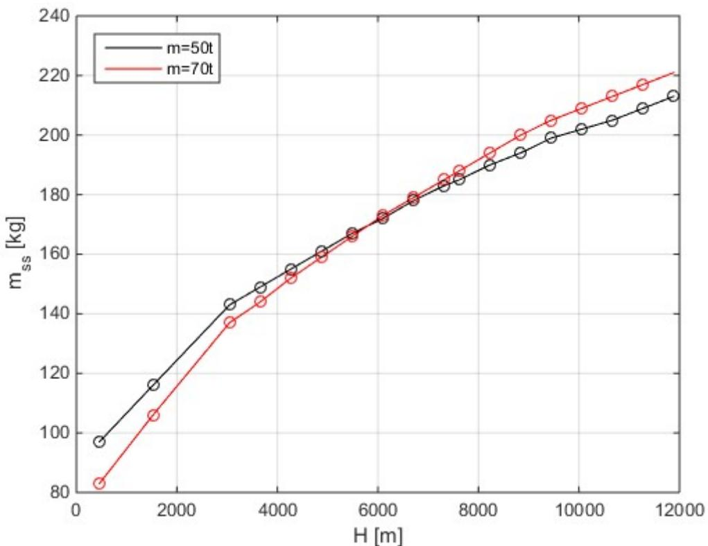
Slika 11 Dijagram mase potrošenog goriva za sruštanje i slijetanje
