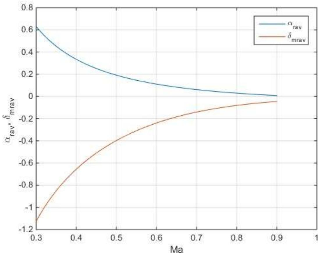
Slika 12 Ovisnost  $\alpha_{\text{rav}}$  i  $\delta_{\text{mrv}}$  o  $Ma$  pri  $m=60 \text{ t}$  i  $H=11277.6 \text{ m}$
