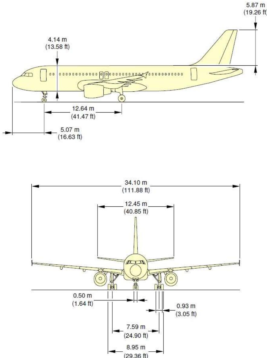
Slika 4 Osnovne dimenzije zrakoplova (nacrt, bokocrt) [4]
