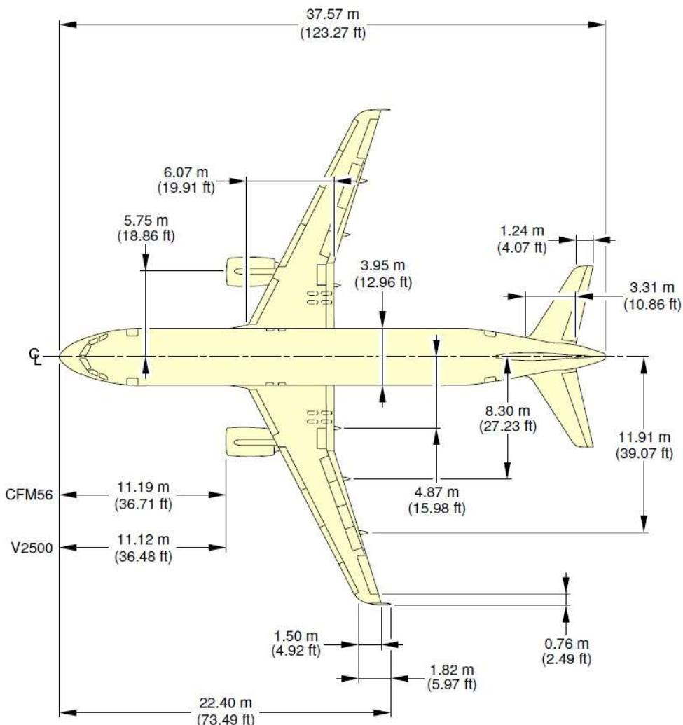
Slika 5 Osnovne dimenzije zrakoplova (tlocrt) [4]
