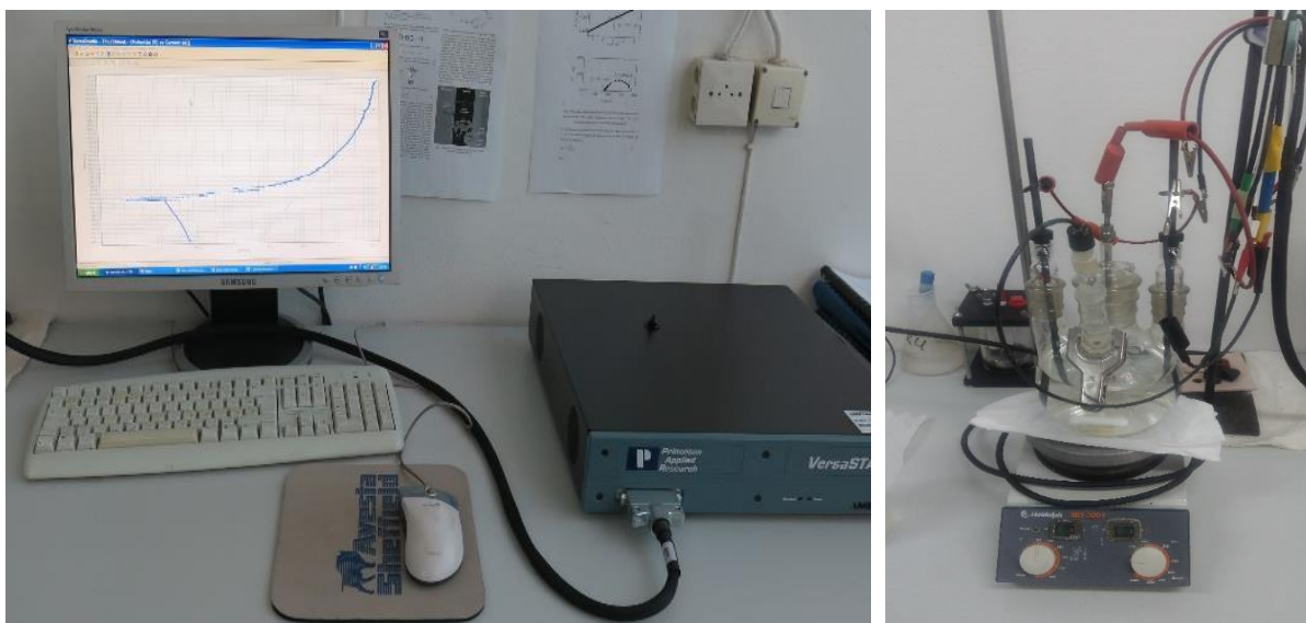
Slika 23. Uređaj VersaSTAT 3 i elektrokemijska ćelija
