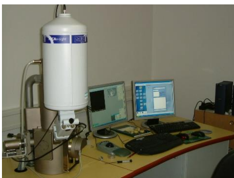
Slika 31 Skenirajući elektronski mikroskop Tescan i EDS analizator
