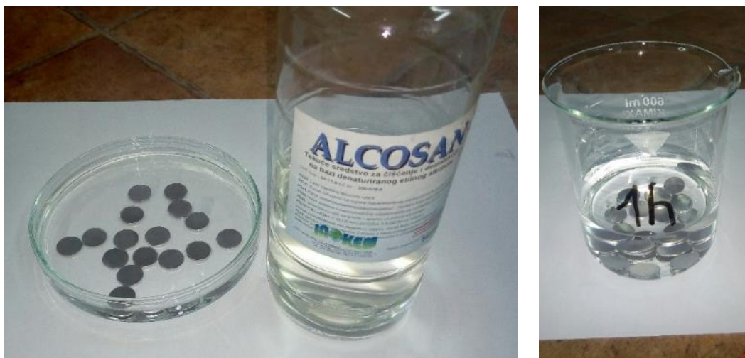
Slika 21. Priprema ispitnih uzoraka - odmaščivanje površine (lijevo) i ispiranje (desno)
